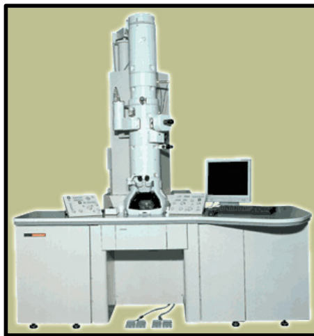
ภาพประกอบ 2-11 เครื่อง Transmission electron microscope (TEM) [20]
