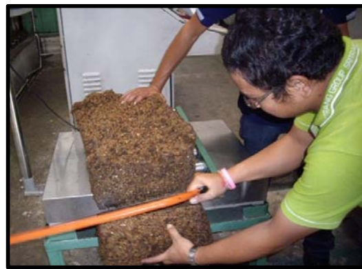
ภาพประกอบ 3-1 ภาพวิธีการตัดตัวอย่างยางขนาด 5.5*7 นิ้ว
