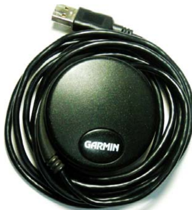
ภาพที่ 3.3 จีพีเอส ยี่ห้อ GARMIN รุ่น GPS 18 USB
