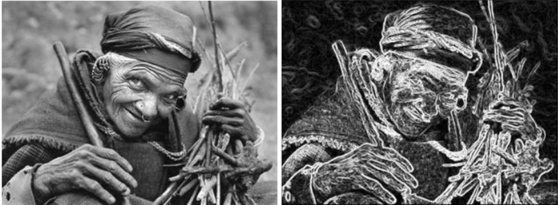
ภาพประกอบ 2-10 ภาพที่ได้จากการหาขอบด้วยวิธีของ Sobel [3]
