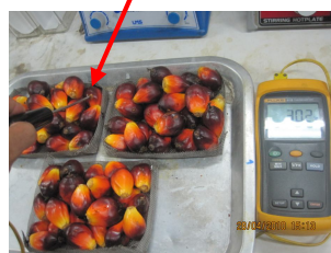
รูปที่ 3.8 การวัดอุณหภูมิและแรงกดที่ผิวผลปาล์มเริ่มยุบตัว
