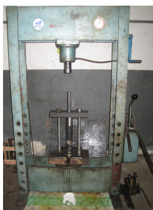
รูปที่ 3.5 ซูดบีบน้ำมันด้วยเครื่องอัดไฮดรอลิกส์
