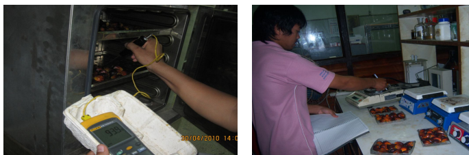
รูปที่ 3.9 การวัดอุณหภูมิและชั่งน้ำหนักของผลปาล์ม
