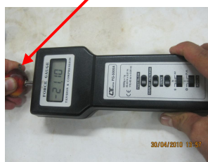
รูปที่ 3.8 การวัดอุณหภูมิและแรงกดที่ผิวผลปาล์มเริ่มยุบตัว
