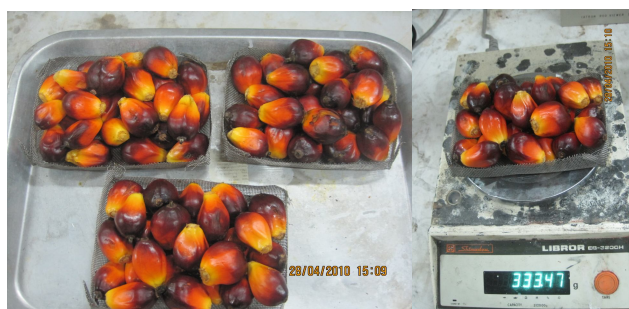
รูปที่ 3.7 การชั่งน้ำหนักตัวอย่างผลปาล์มก่อนเข้าสู่อบไฟฟ้า
