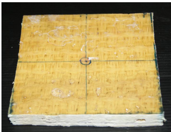
รูปที่ ๓.6 วัสดุผสมทำมาจากเส้นใยเคฟล่าจัดเรียงซ้อนกัน 3 ชั้น(แบบที่ 6)
