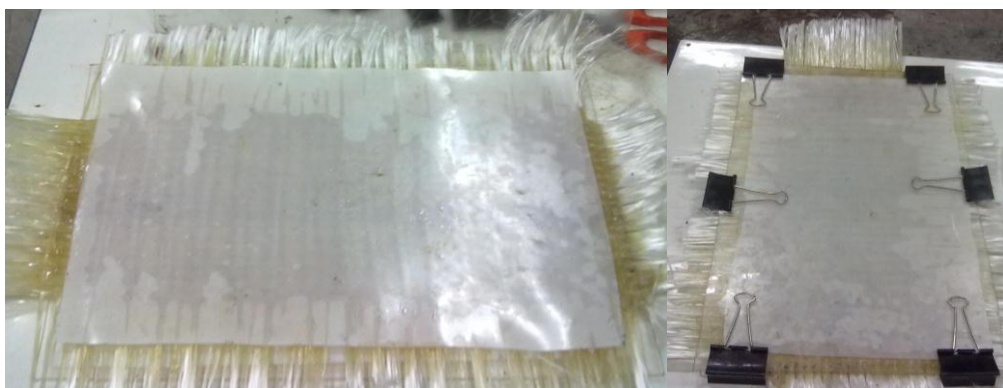
รูปที่ 3.13 แผ่นฟิล์มไมลาร์ (Mila) ที่มาประกบบนชิ้นงานที่ทอที่พ็อกซ์เสร็จแล้ว
