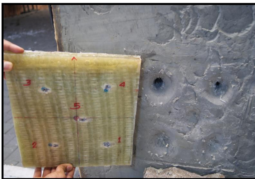
รูปที่ ง.13 รอยการยิงบนชิ้นทดสอบและรอยบุ๋มบนกระเบดิน
