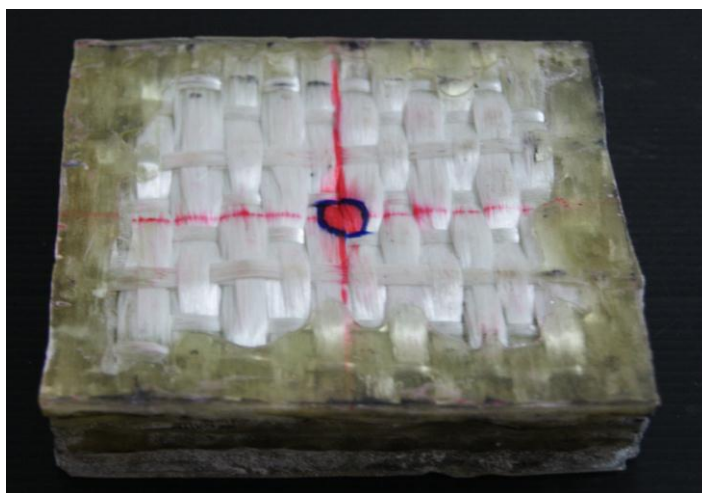
รูปที่ ๓.5 เส้นใย E-glass จัดเรียงซ้อนกัน 6 ชั้น ไม่ขึ้นรูปเป็นวัสดุผสม (เส้นใยทอแบบ 3-D orthogonal วางซ้อนกันเป็นชั้นๆ : แบบที่ 5)
