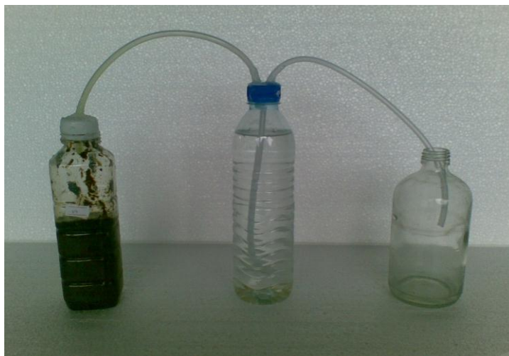
รูปที่ 3.5 ระบบผลิตแก๊สชีวภาพในระดับห้องปฏิบัติการ (พรเทพ, 2551)
