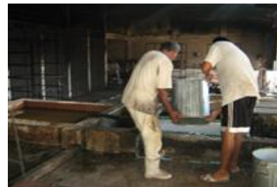
ฉ) เทน้ำยางลงบ่อพัก
