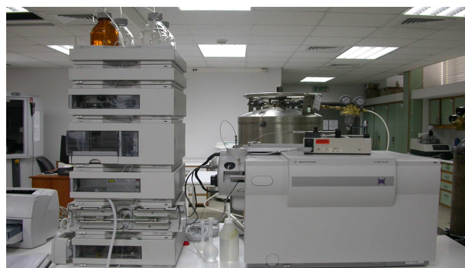
ภาพประกอบที่ 3-7 แสดงเครื่องวิเคราะห์ HPLC MS
