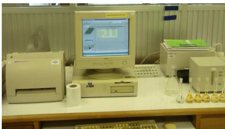
ภาพประกอบที่ 3-4 แสดงเครื่อง UV-vis Spectrophotometer รุ่น (HEWLETT PACKARD 8453) สำหรับใช้วิเคราะห์หาเหล็กเฟอร์รัส Fe^{2+} และความเข้มข้นสีในน้ำเสีย
