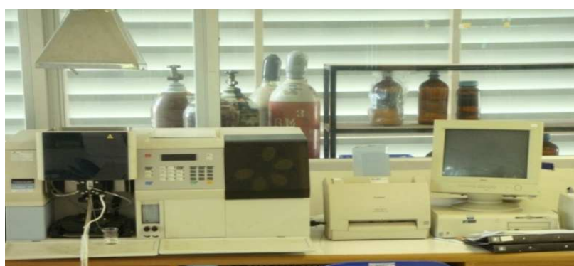
ภาพประกอบที่ 3-5 แสดงเครื่อง Atomic Absorption Spectrometer (AAS) รุ่น (Perkin Elmer model AA Analyst) สำหรับใช้วิเคราะห์ปริมาณเหล็กรวม
