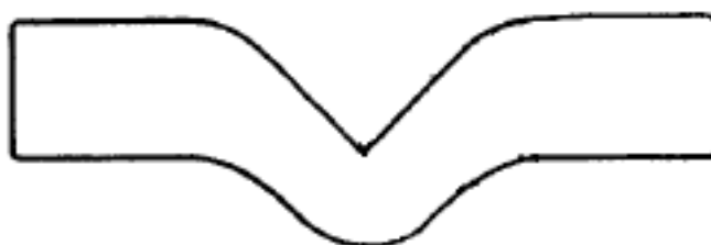
รูปที่ 3.3 ชิ้นทดสอบแบบมุมสำหรับการทดสอบการฉีกขาด
