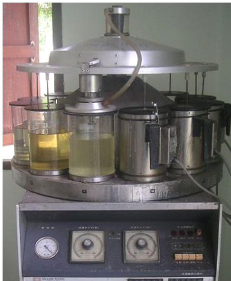
ภาพที่ 9 แสดงการดึงน้ำออกจากเนื้อเยื่อ (Dehydration) ด้วยเครื่องเตรียมเนื้อเยื่ออัตโนมัติ
