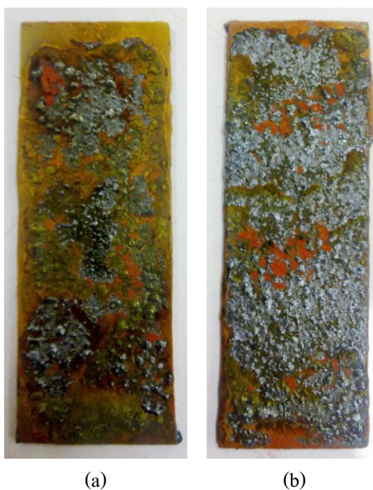
รูปที่ 3.3 ผิวเคลือบที่สังเคราะห์ได้จากการทดลองที่มีผิวเคลือบตั้งต้นหนา a) 1 mm และ b) 2 mm บนชิ้นงานตัวอย่างที่มีความหนา 1.2 mm
