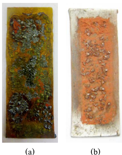
รูปที่ 3.4 ผิวเคลือบที่สังเคราะห์ได้จากระบบที่ใช้ a) พอลิไวนิลแอลกอฮอล์ และ b) เมทิลเซลลูโลส เป็นตัวประสาน
