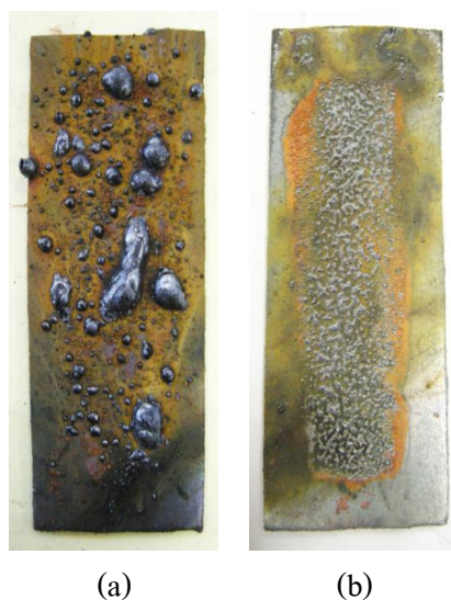
รูปที่ 3.12 ผิวเคลือบที่สังเคราะห์ได้จากการทดลองที่ใช้ส่วนผสมตั้งต้นเป็น a) ผง และ b) คอลลอยด์
