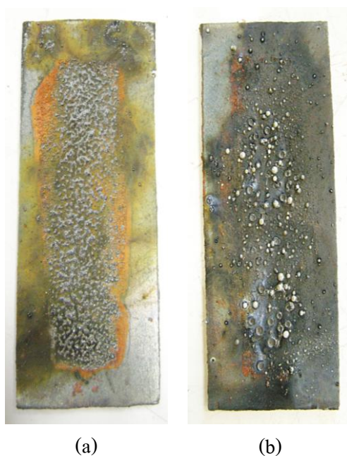
รูปที่ 3.9 ผิวเคลือบที่สังเคราะห์ได้จากการทดลองที่ใช้น้ำกลั่นเป็นตัวทำละลายและเติม a) ไม่เติม สารตัวเติม และ b) 1 โมลอะลูมินเนียม
