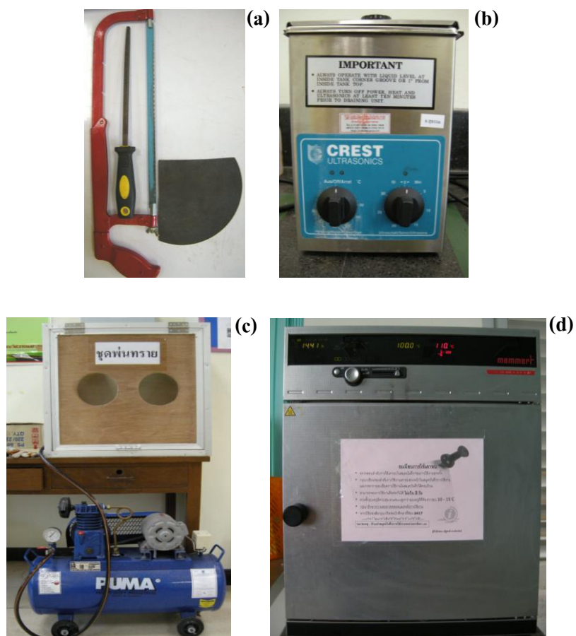
รูปที่ 2.2 วัสดุ อุปกรณ์ และเครื่องมือที่ใช้ในการเตรียมชิ้นงานตัวอย่าง (a) Hack Saw, Filing and Silicon Carbide Grinding Paper (b) Ultrasonic Cleaner (c) Sand Blasting Set และ (d) Oven
