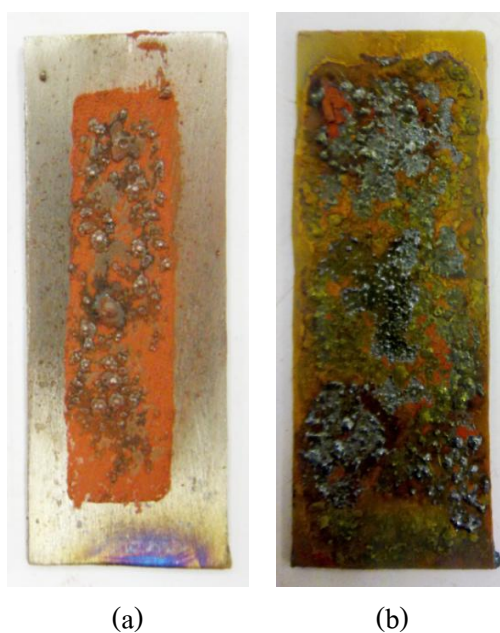
รูปที่ 3.5 ผิวเคลือบที่สังเคราะห์ได้จากการทดลองที่ใช้สารละลายตัวประสานที่มีพอลิไวนิล แอลกอฮอล์ในสัดส่วน a) ร้อยละ 1 โดยน้ำหนัก และ b) ร้อยละ 2 โดยน้ำหนัก
