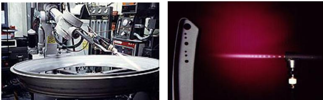
รูปที่ 1.7 ลักษณะการพ่นเคลือบด้วยระบบ HVOF ( http://www.5tigers.co.th สืบค้นเมื่อ 13 ธันวาคม 2552)
