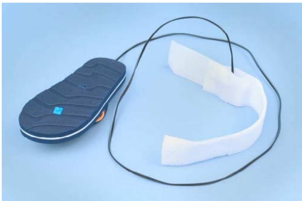
ภาพประกอบ 1-2 แสดง Tactile Feedback Pressure Sensor Device[16]
