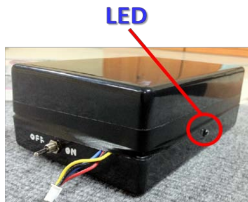
ภาพประกอบ 4-13 แสดงลักษณะของกล่องควบคุมการทำงาน (controller box)
