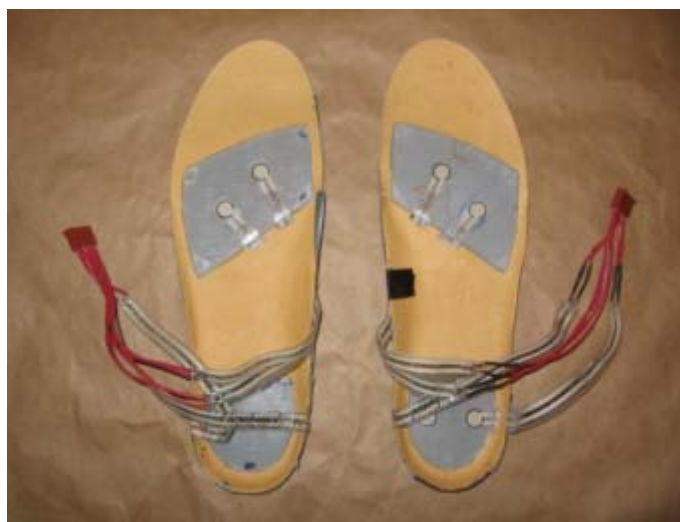
ภาพประกอบ 1-4 แสดงอุปกรณ์สำหรับตรวจวัดแรงแบบไดนามิก[17]
