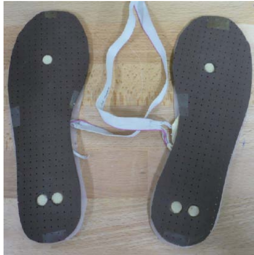
ภาพประกอบ 4-12 แสดงลักษณะของแผ่นรองรองเท้าที่ใช้ในเครื่องมือต้นแบบ
