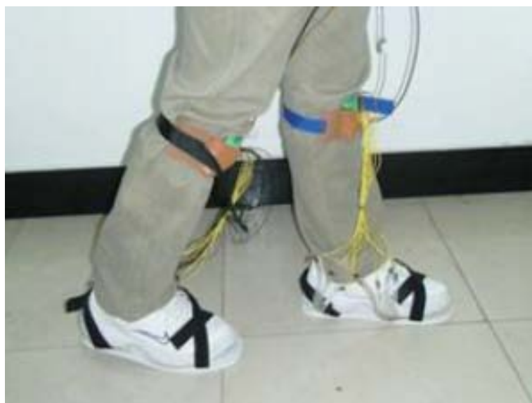
ภาพประกอบ 1-7 แสดงลักษณะของ Plantar pressure signal acquisition system[19]
