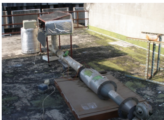
ภาพประกอบที่ 3.2 เครื่องอบแห้งพลังงานแสงอาทิตย์ร่วมกับลมร้อน
