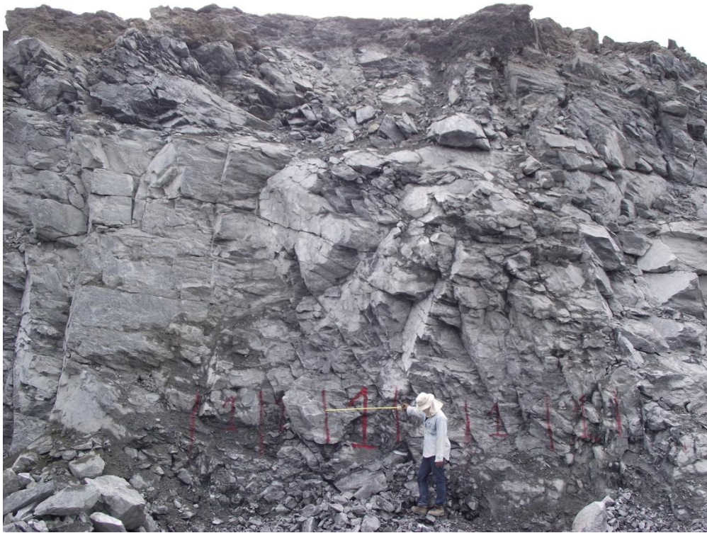
รูปที่ ข 1-5 หน้าระเบิดการระเบิดโดยใช้กรวยอุดระเบิด วันที่ 5
