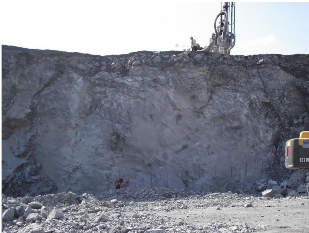
รูปที่ ข 1-4 หน้าระเบิดการระเบิดโดยใช้กรวยอุดระเบิด วันที่ 4
