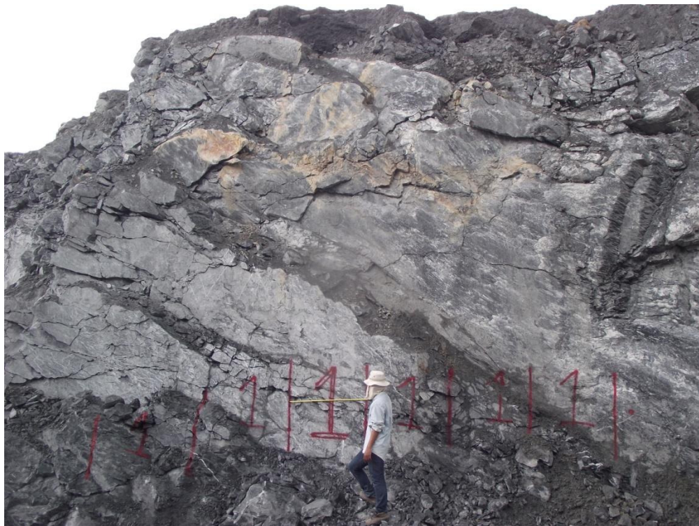
รูปที่ ข 1-6 หน้าระเบิดการระเบิดโดยใช้กรวยอุดระเบิด วันที่ 6
