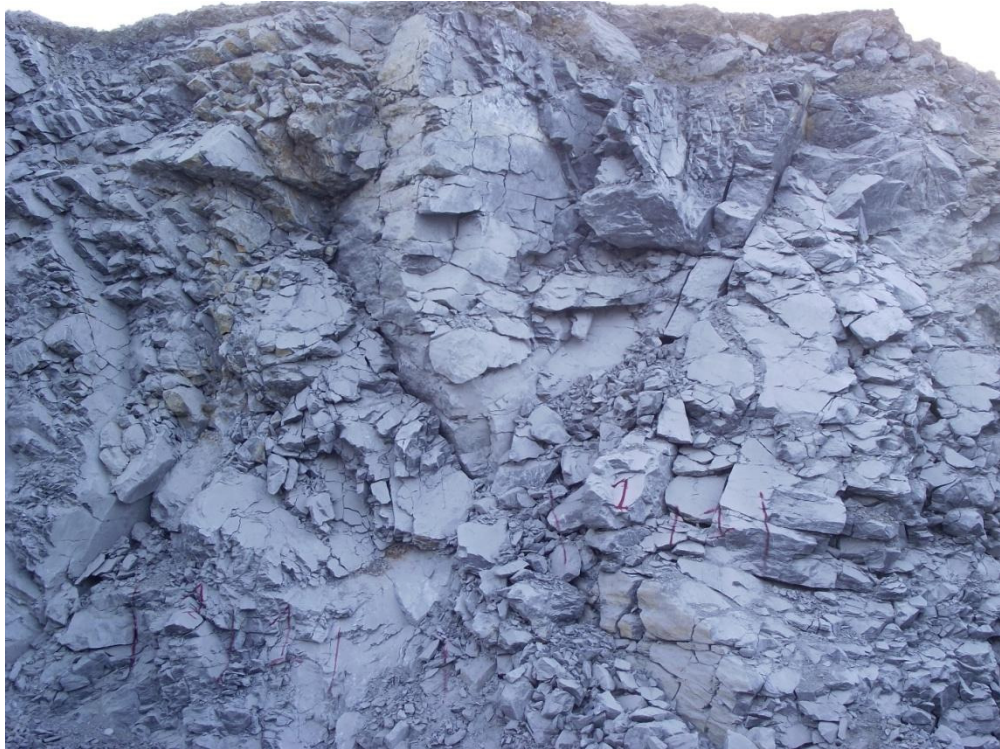
รูปที่ ข 1-9 หน้าระเบิดการระเบิดโดยใช้กรวยอุดระเบิด วันที่ 9
