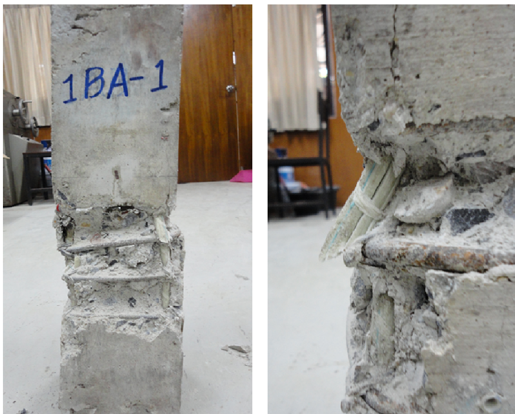
รูปที่ 4.9 การวิบัติของเสาในกลุ่ม SFsn
