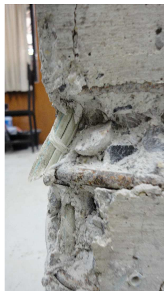
รูปที่ 8 รูปแบบการบิดเบี้ยวเนื่องจากการดึงและการโก่งตัวของวัสดุเสริมกำลังด้วย GFRP
