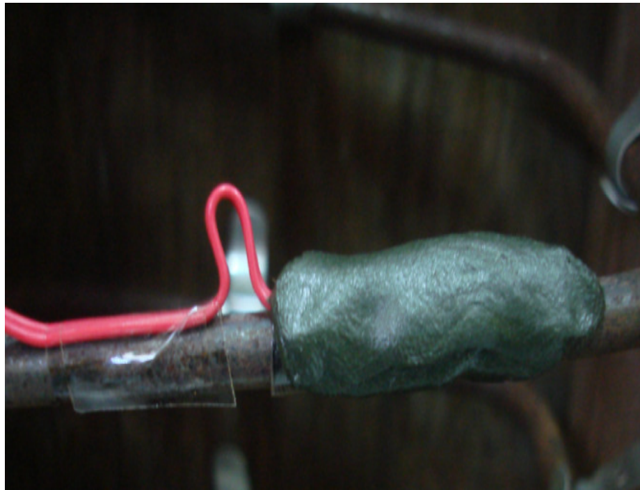
(ข) สเตรนเกจที่พอกด้วยวัสดุเคลือบผิว Coating Agent
