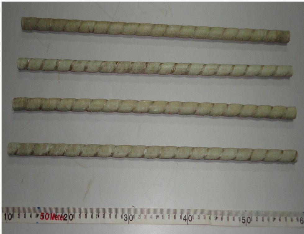
รูปที่ 3.15 วัสดุพอลิเมอร์เสริมกำลังด้วยเส้นใย (Fiber Reinforced Polymer – FRP) ขนาดเส้นผ่านศูนย์กลาง 10 มิลลิเมตร
