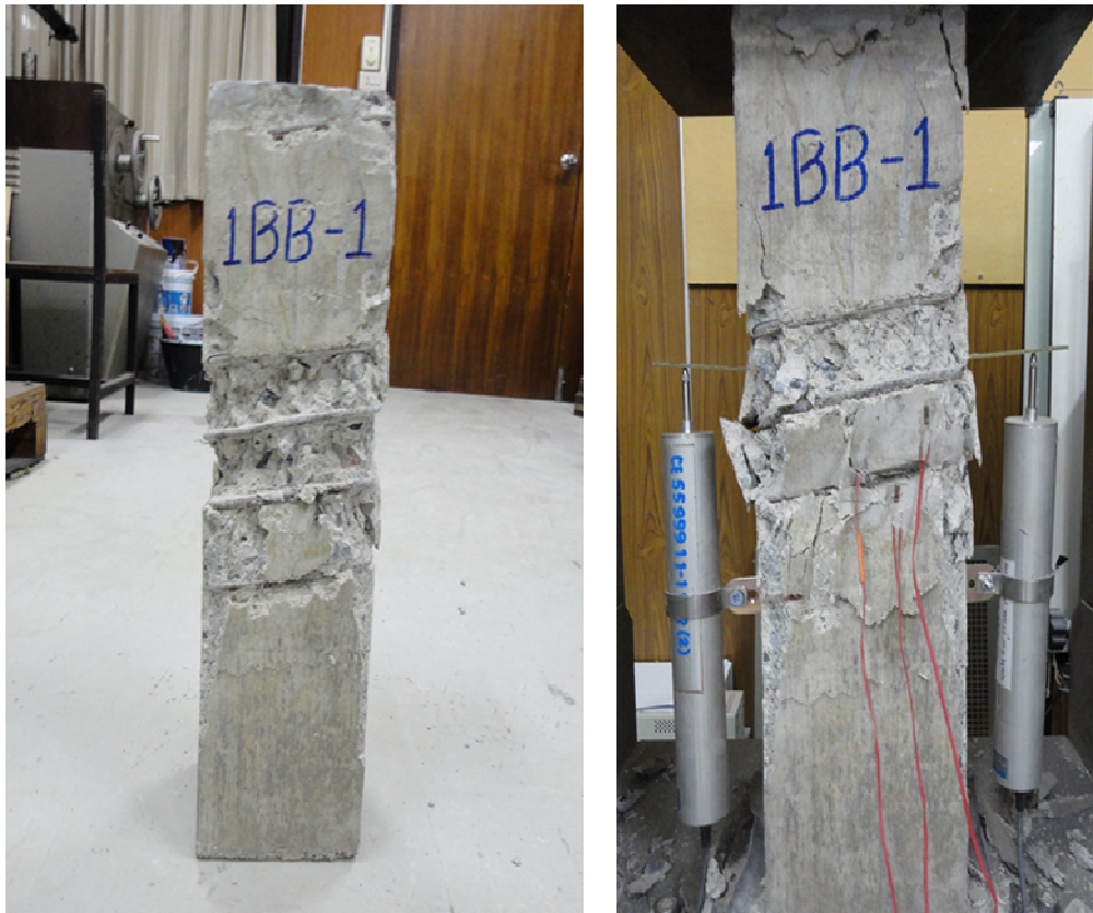
รูปที่ 4.12 การวิบัติของเสาในกลุ่ม SNsn
