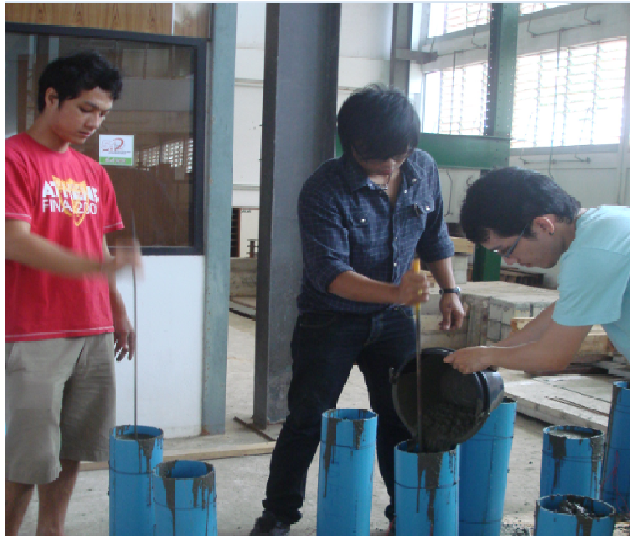
รูปที่ 3.10 รูปตอนเทคอนกรีตลงแบบหล่อ
