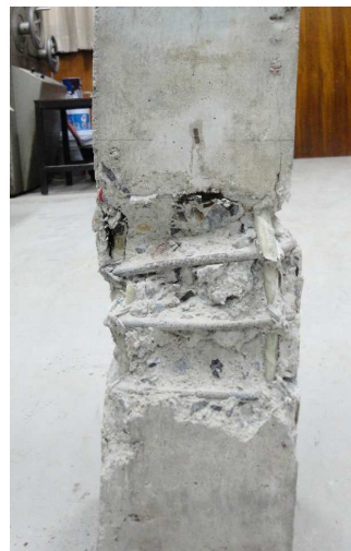
รูปที่ 7 รูปแบบการบิดเบี้ยวของวัสดุเสริมกำลังด้วย GFRP
