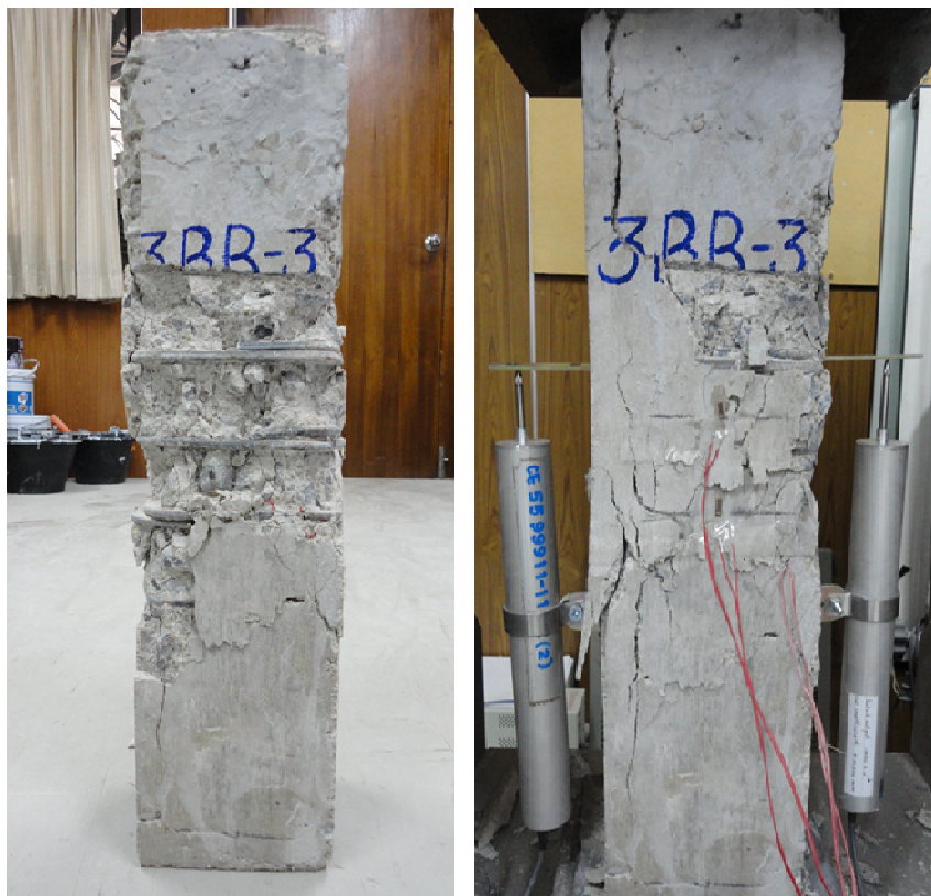
รูปที่ 4.36 การวิบัติของเสากลุ่ม SNtn
