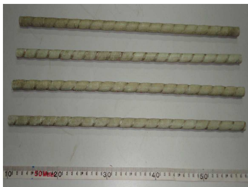
รูปที่ 1 แท่งพอลิเมอร์เสริมกำลังด้วยเส้นใยแก้วที่ใช้ในการทดสอบ
