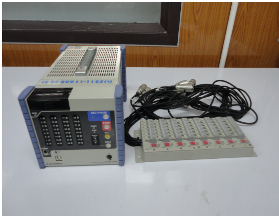
รูปที่ 3.14 เครื่องเก็บข้อมูล (Data Logger) รุ่น EDX 100 ยี่ห้อ KYOWA
