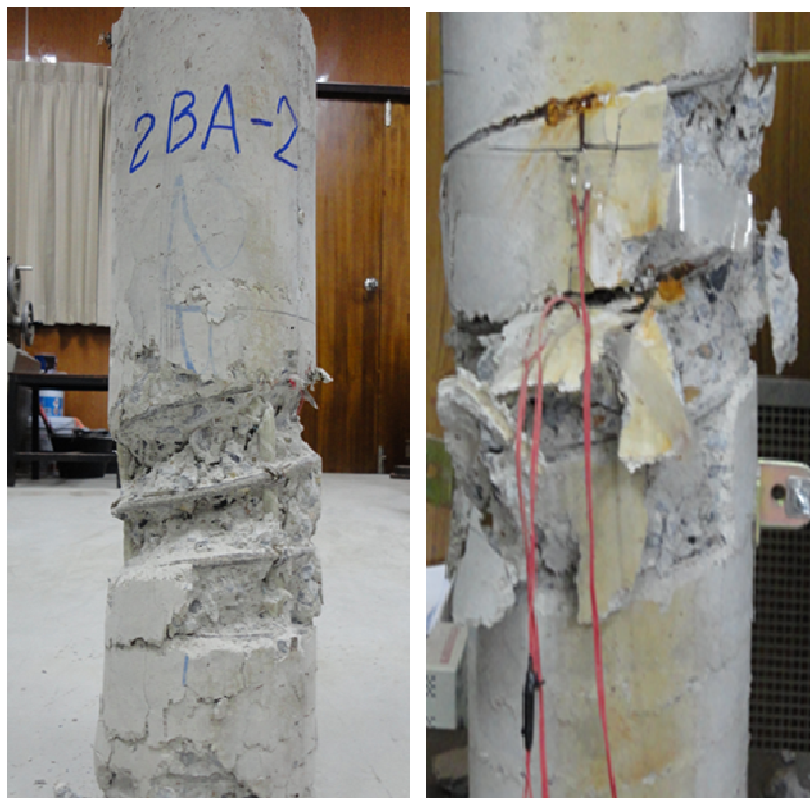
รูปที่ 4.24 การวิบัติของเสากลุ่ม CNsn
