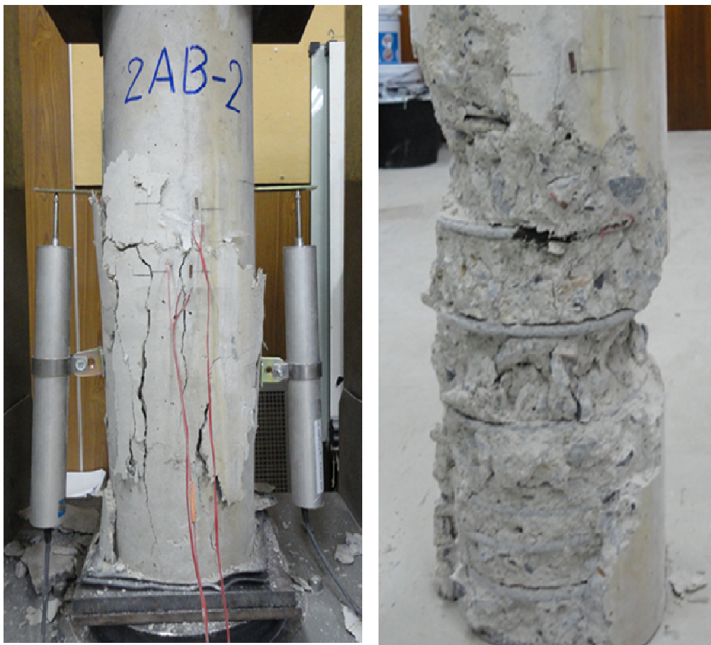
รูปที่ 4.18 การวิบัติของเสากลุ่ม CNsc
