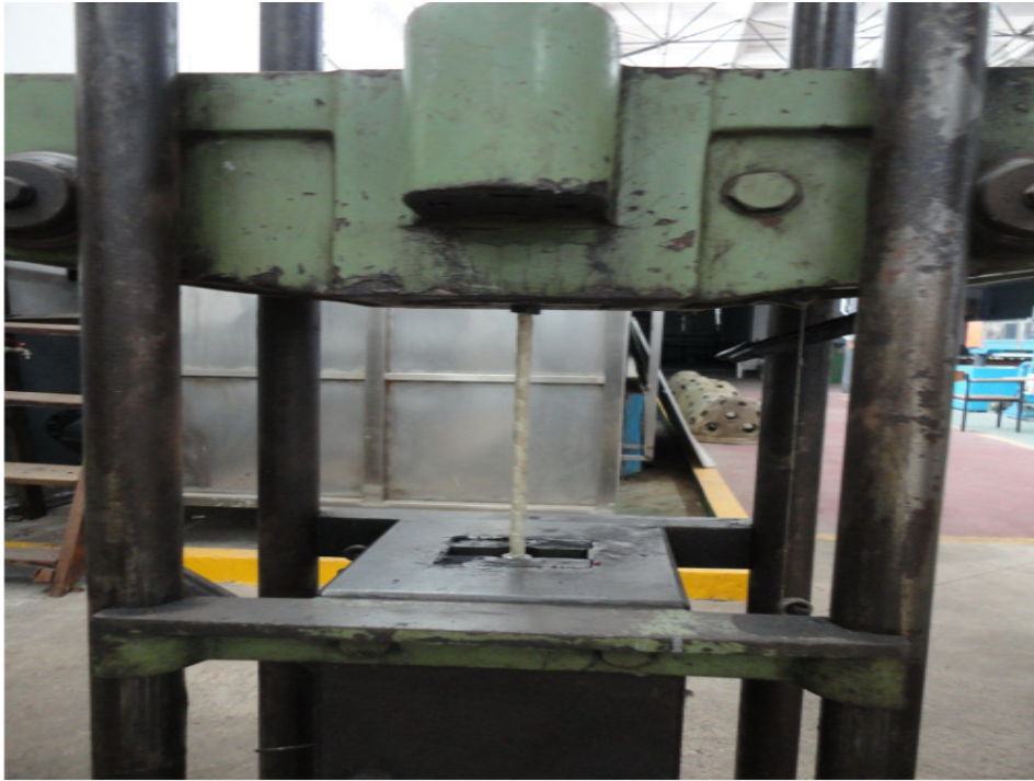
รูปที่ 3.17 การทดสอบหาแรงดึงของวัสดุพอลิเมอร์เสริมกำลังด้วยเส้นใย
