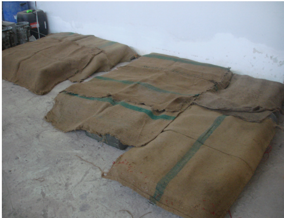
รูป 3.11 การบ่มตัวอย่างเสาในงานวิจัย
