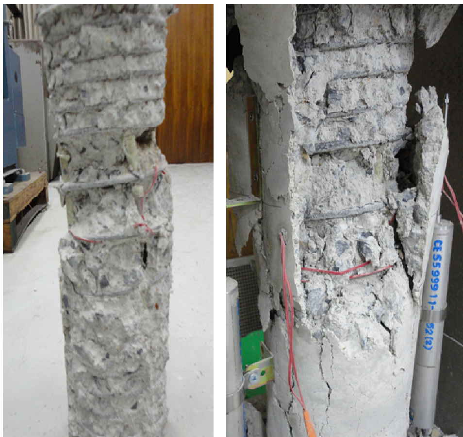
รูปที่ 4.15 การวิบัติของเสากลุ่ม CFsc
