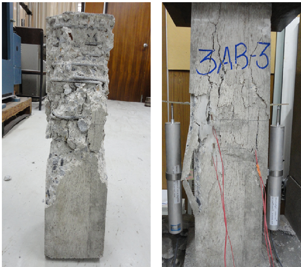
รูปที่ 4.30 การวิบัติของเสากลุ่ม SNtc
