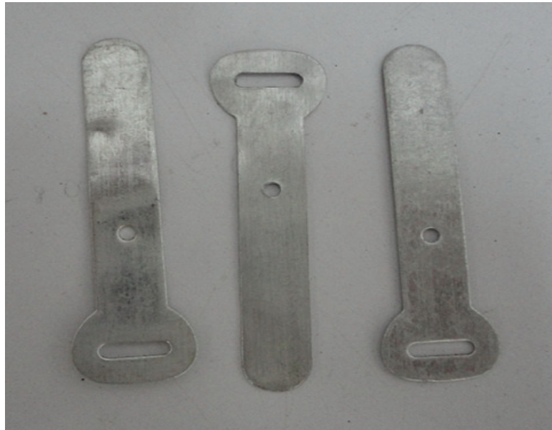
รูปที่ 3.4 ก๊ีบที่ใช้ยึดติดระหว่างเหล็กปลอกกับแบบหล่อ
