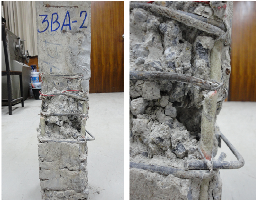
รูปที่ 4.33 การวิบัติของเสากลุ่ม SFsn
