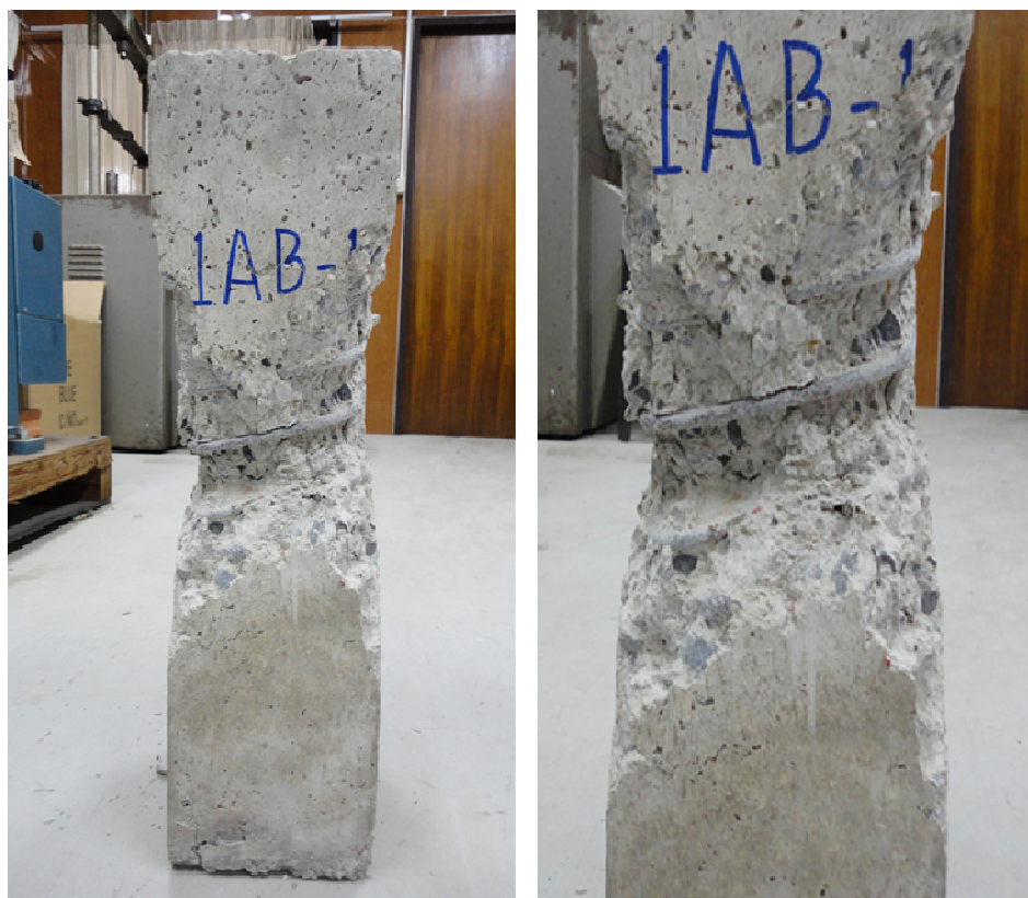
รูปที่ 4.6 การวิบัติของเสาในกลุ่ม SNsc
