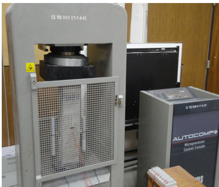
รูปที่ 3.12 เครื่องทดสอบ Universal Testing Machine
