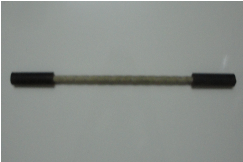
รูปที่ 3.16 แป๊ปเหล็กที่ใช้กาวแรงยึดสูงยึดติดกับวัสดุพอลิเมอร์เสริมกำลังด้วยเส้นใย
