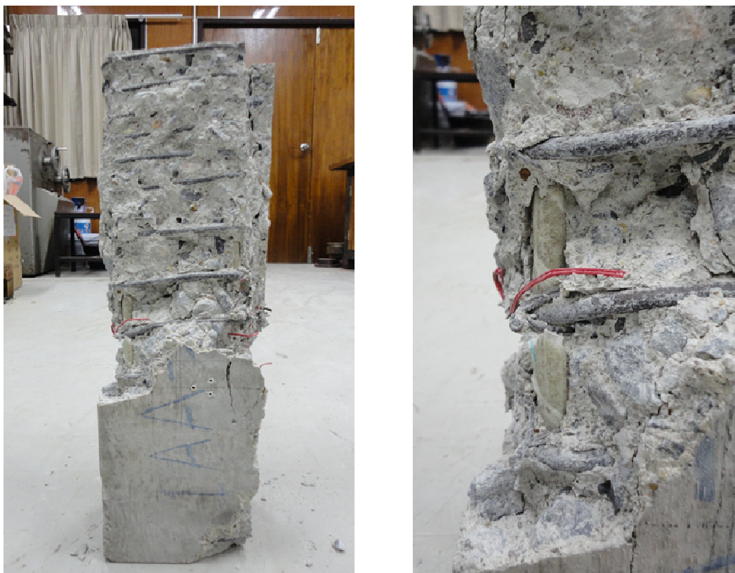
รูปที่ 4.3 การวิบัติของเสากลุ่ม SFsc
