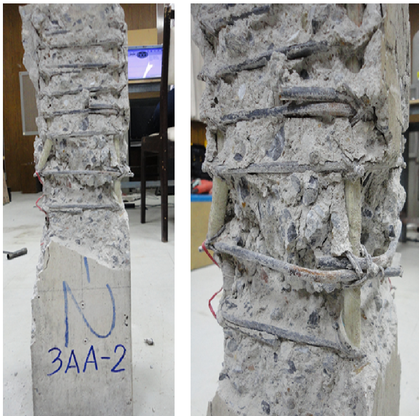
รูปที่ 4.27 การวิบัติของเสาในกลุ่ม SFtc
