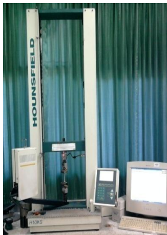
รูปที่ 3.3 เครื่องทดสอบความต้านทานต่อแรงดึง
