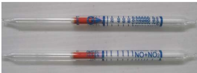
ภาพประกอบที่ 3-21 แสดง Gas detector tube ของสารกลุ่ม NO x
