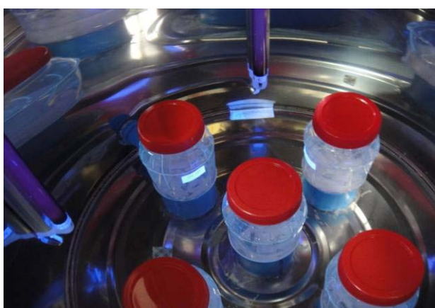
ภาพประกอบที่ 3-15 แสดงการฉายแสงอัลตราไวโอเล็ตจากหลอดไฟในการทดลองบำบัดแอมโมเนียที่ปนเปื้อนในของเหลวด้วยปฏิกรณ์โฟโตแคตะไลติก
