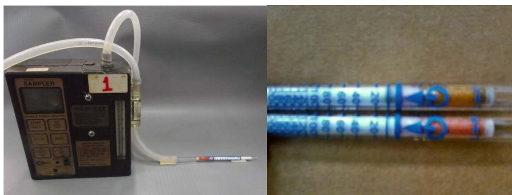
ภาพประกอบที่ 4-22 แสดงวิธีการและผลการตรวจสอบปริมาณ NO x ด้วย Gas detector tube
