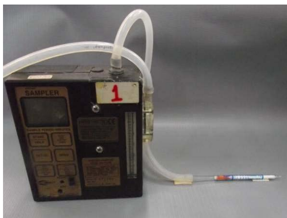
ภาพประกอบที่ 3-22 แสดงวิธีการเก็บตัวอย่างการวิเคราะห์ความเข้มข้นของสารกลุ่ม NO x ด้วย gas detector tube
