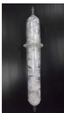
ภาพประกอบที่ 4-9 แสดงคอลัมน์ที่บรรจุด้วยใยแก้วที่เคลือบบนโฟโตแคตะลิสต์ชนิด \text{TiO}_2\text{-SiO}_2
