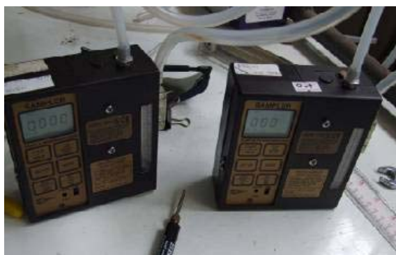
ภาพประกอบที่ 3-16 ปั๊มเก็บตัวอย่างอากาศเสียเพื่อวัดความเข้มข้นของแอมโมเนียในอากาศ
