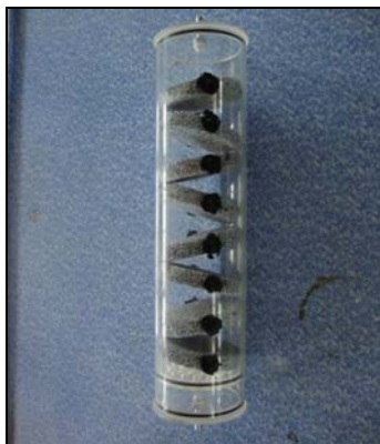
ภาพประกอบที่ 4-7 แสดงคอลัมน์บรรจุเซรามิกโฟมที่เคลือบด้วยโฟโตแคตะไลสต์ชนิด \text{TiO}_2\text{-SiO}_2
