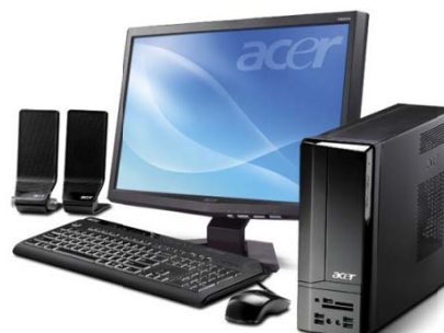
ภาพประกอบ 4-38 โหลดแบบไม่เป็นเชิงเส้นที่ใช้วัดปริมาณกำลังไฟฟ้าตามมาตรฐาน IEEE 1459-2010
