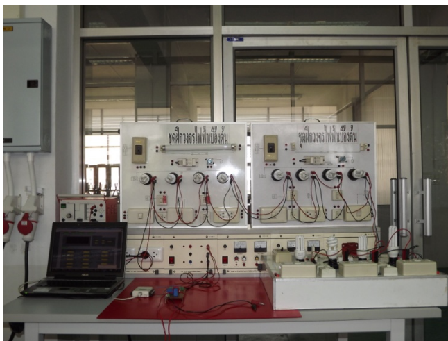
ภาพประกอบ 4-39 หลอดคอมแพคฟลูออเรสเซนต์ สำหรับการทดลองวัดปริมาณกำลังไฟฟ้า
