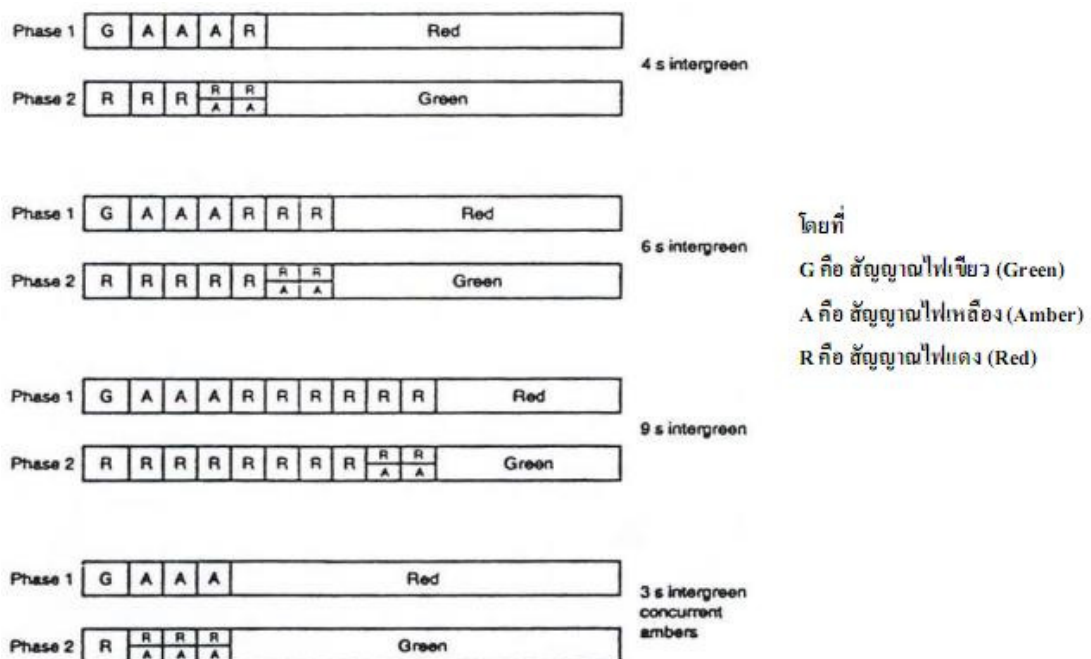
ภาพที่ 2.4 ตัวอย่างของ Intergreen Periods ของระบบสัญญาณไฟ (ที่มา: Salter and Hounsell .1996)
