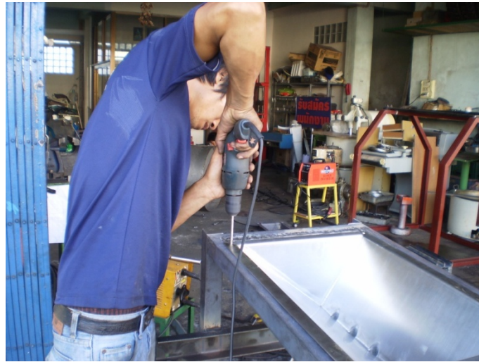
รูปที่ 4.2 การประกอบหม้อสแตนเลสเข้ากับโครงของเครื่อง
