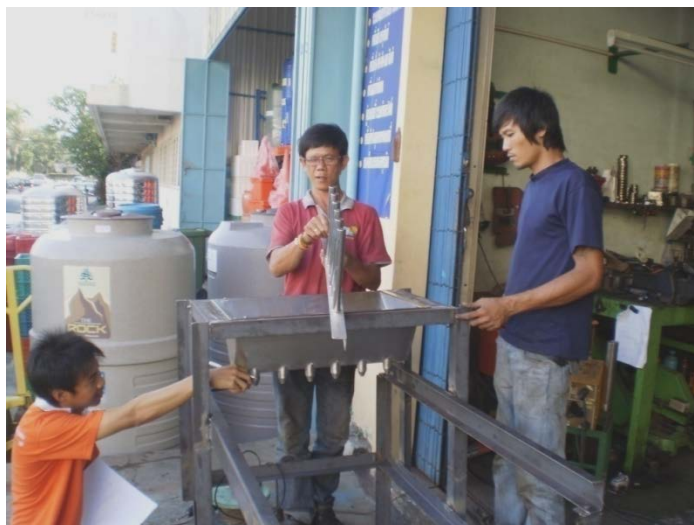
รูปที่ 4.3 การทดลองประกอบชุด เปิด-ปิด รุหยอดน้ำตาล
