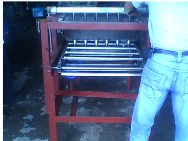
รูปที่ 4.7 บล็อกสำหรับวางแวนที่ยึดติดกับโซ่ข้อปึกเรียบร้อยแล้ว
