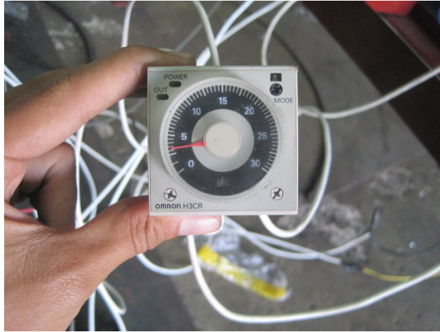
รูปที่ 4.12 การติดตั้งไทม์เมอร์
