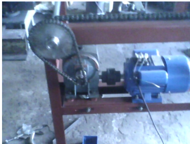
รูปที่ 4.5 มอเตอร์และชุดเกียร์ทดที่ประกอบเข้ากับโครงของเครื่อง
