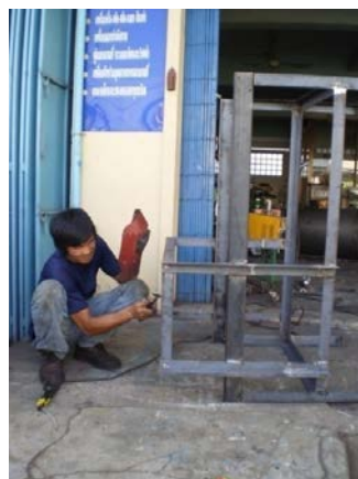
รูปที่ 4.1 การประกอบโครงของเครื่องช่วยผลิตน้ำตาลแว่น
