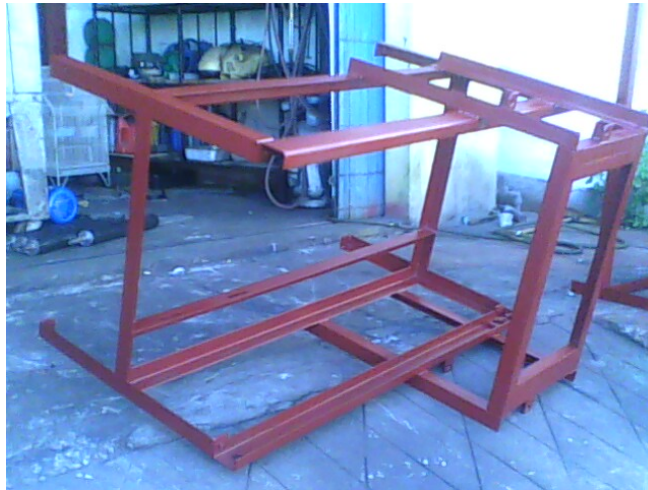
รูปที่ 4.4 โครงเครื่องที่ทาสีกันสนิม
