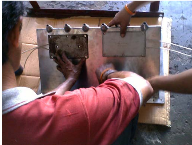
รูปที่ 4.10 การติดตั้งเทอร์มินัลเข้ากับหม้อฉนวนน้ำตาล
