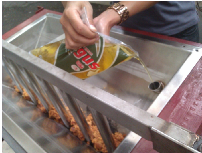
รูปที่ 4.18 การเติมน้ำมันในหม้ออุ่นน้ำผึ้ง
