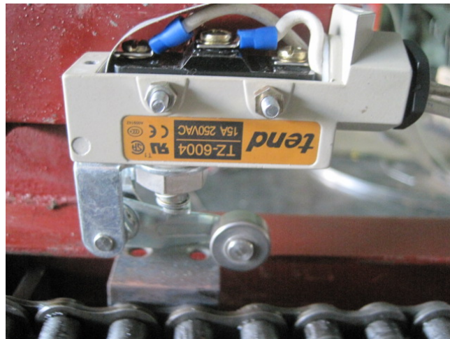
รูปที่ 4.11 ลิมิทสวิตช์ที่ถูกติดตั้ง
