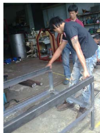
รูปที่ 4.1 การประกอบโครงของเครื่องช่วยผลิตน้ำตาลแว่น
