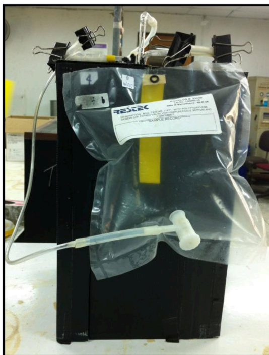
ภาพประกอบที่ 3.5 ลักษณะการทำงานของระบบบำบัดไม่ใช้อากาศแบบ Semi-batch
