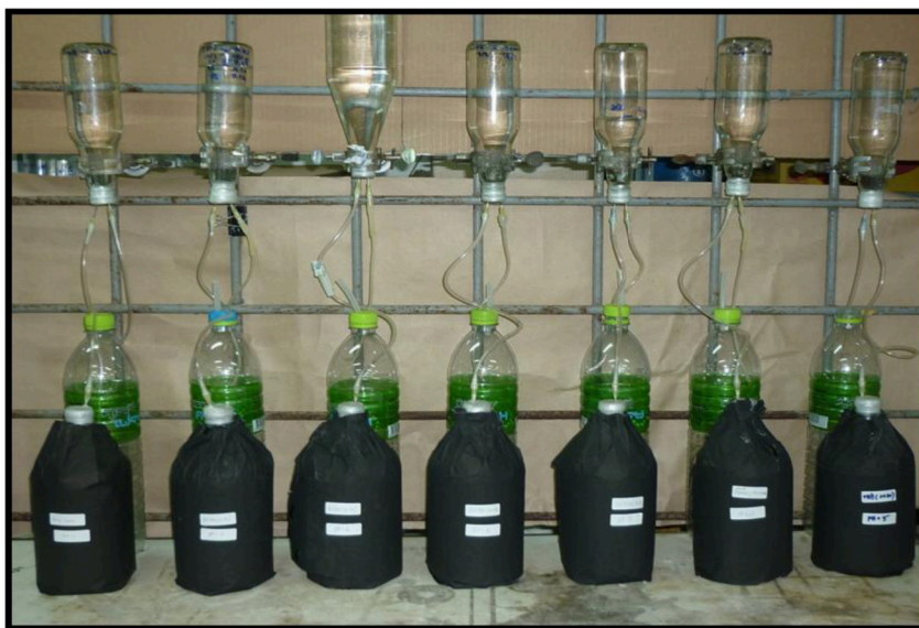
ภาพประกอบที่ 3.3 ลักษณะการทำงานของระบบหมักแบบ batch โดยทำการหมักในที่มืดแสงสว่างน้อย
