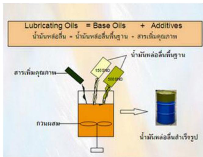
ภาพประกอบที่ 1-1 ขั้นตอนการเตรียมน้ำมันหล่อลื่นจากน้ำมันพื้นฐานปิโตรเลียม ที่มา: Society of Automotive Engineer (2551)
