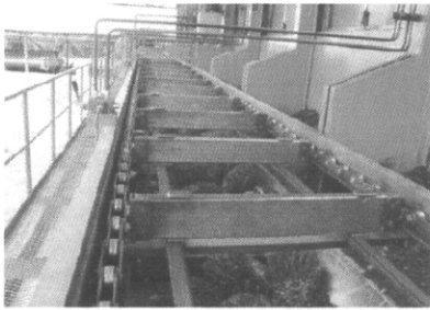
รูปที่ 2.13 ลำเลียงทะเลายปาล์มสดจากช่องรับปาล์มลงในกระบะใส่ปาล์ม
