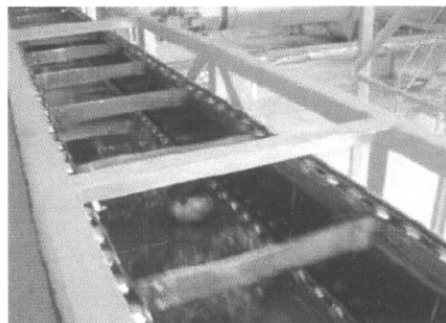
รูปที่ 2.16 เครื่องแยกทะเลลายกับผลปาล์มออกจากกัน
