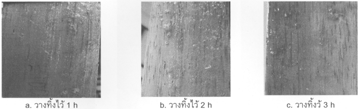
รูปที่ 4.24 ภาพไม้ยางพาราเคลือบด้วย ESO100 ที่มีการบ่มสารละลาย ESO100 ที่อุณหภูมิห้องเป็นเวลา 1-3 h ก่อนนำไปเคลือบบนไม้ยางพารา อบชิ้นไม้ยางพาราที่ 150°C เป็นเวลา 1 h
