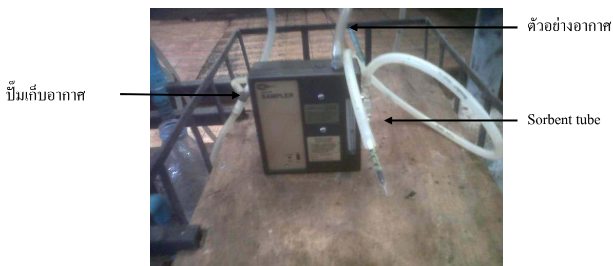
ภาพประกอบ 3-10 แสดงวิธีการเก็บตัวอย่างด้วยปั๊มเก็บอากาศ และ Sorbent tube
