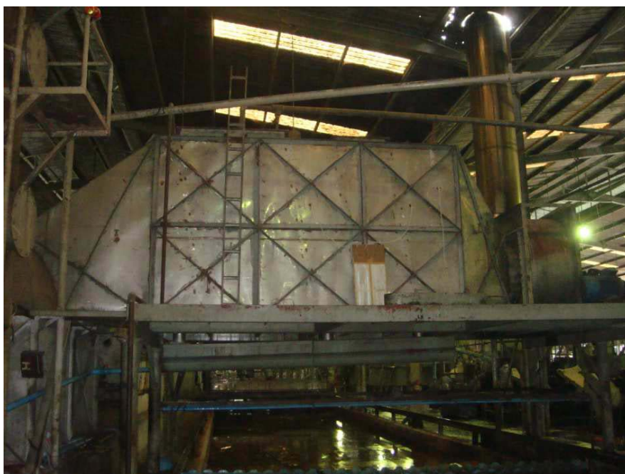
ภาพประกอบที่ 3-16 แสดงหอดูดซึมแนวนอนขนาดอุตสาหกรรมที่ใช้จริงในการบำบัดกรดอะซิติกจากปล่องควันจากกระบวนการอบยางแท่งของ บริษัท สยามอินโดรรับเบอร์ จำกัด จ.พัทลุง
