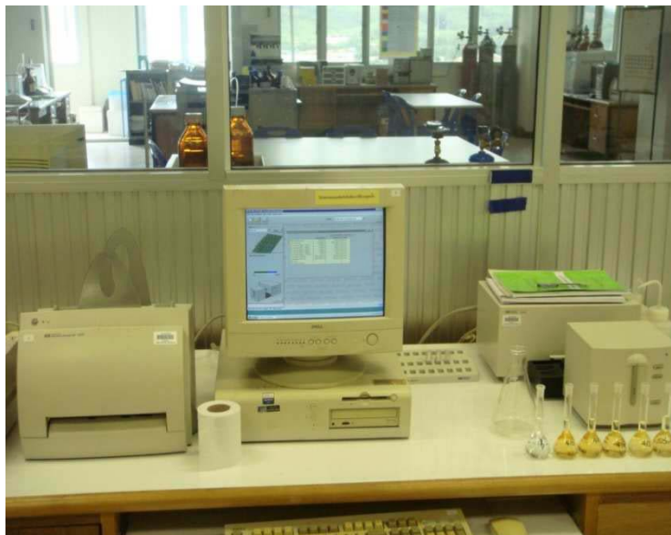
ภาพประกอบที่ 3-1 แสดงเครื่อง UV-Spectrophotometer สำหรับใช้วิเคราะห์หาเหล็กเฟอรัส Fe(II) (HEWLETT PACKARD 8453)
