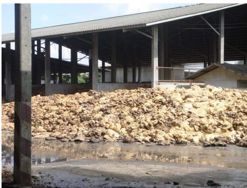
ภาพประกอบที่ 5-3 แสดงพื้นที่เก็บหรือพักยางก้อนถ้วยก่อนผ่านกระบวนการตัดและการล้างทำความสะอาดของ บริษัท สยามอินโด รีบเบอร์ จำกัด
