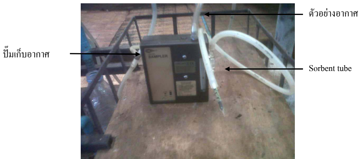
ภาพประกอบ ข-2 แสดงวิธีการเก็บตัวอย่างด้วยปั๊มเก็บอากาศ และ Sorbent tube
