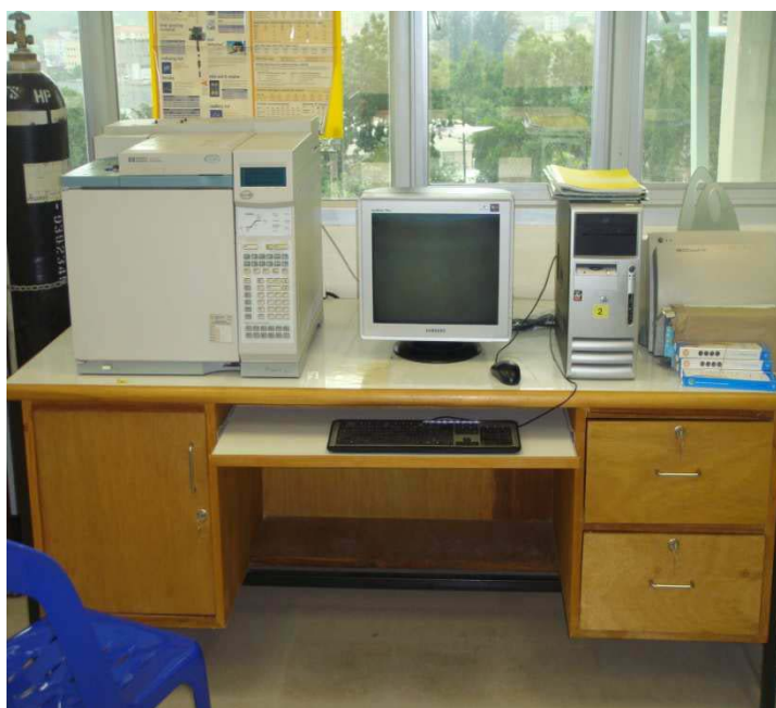
ภาพประกอบที่ 3-3 แสดงเครื่องวิเคราะห์ Gas chromatography (GC 6890)
