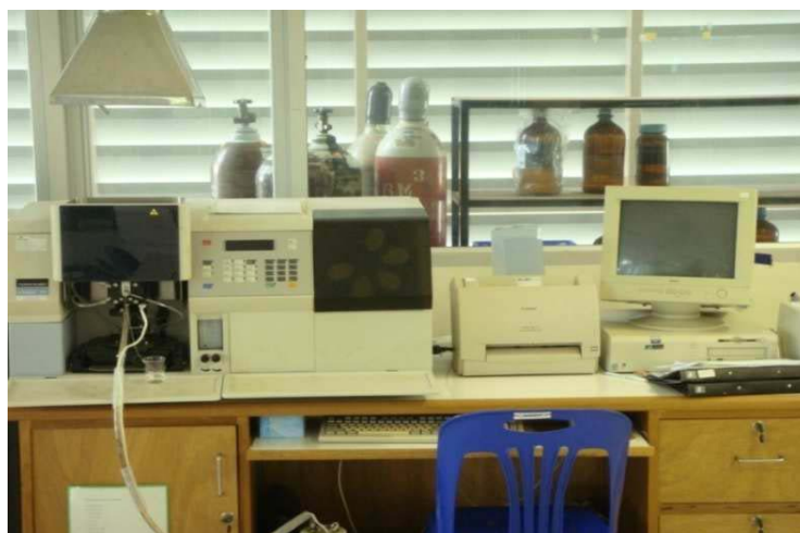
ภาพประกอบที่ 3-2 แสดงเครื่อง Atomic absorption spectrometer (AAS) สำหรับใช้วิเคราะห์ ปริมาณเหล็กรวม (Perkin Elmer model AA Analyst)
