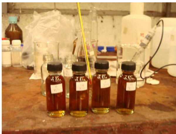
ภาพประกอบที่ 3-12 แสดงการเก็บตัวอย่างสารดูดซึมจากการทำปฏิกิริยามาทำการวิเคราะห์ความเข้มข้นที่เวลาต่างๆ
