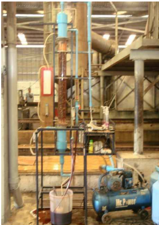
ภาพประกอบที่ 3-8 แสดงหอดูดซึมแบบเป็ยก ชนิดแพคคอลัมน์ ขนาดต้นแบบที่ใช้ในการบำบัด ก๊าซเสียจากปล่องควัน ติดตั้งที่บริษัทสยามอินโด รีบเบอร์ จำกัด อ.ตะโหนด จ.พัทลุง
