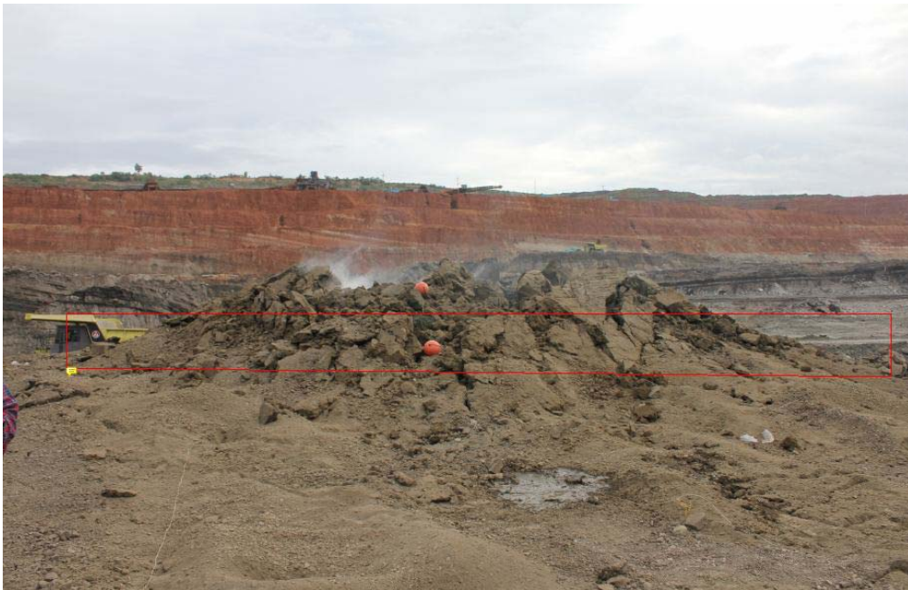
รูปที่ ผ6-13 ชุดการศึกษาที่ 12 รูปแบบของการศึกษาระเบิดเป็นแผง โดยมีการระเบิดหน้าเรียบ ถ่วงหน้า โดยเทคนิคการระเบิดเว้นช่องลมขนาดหัวเจาะ 181 มิลลิเมตร ระยะห่างระหว่างรูเจาะ 18.4 เท่าของขนาดรูเจาะหรือ 3.3 เมตร ที่ความลึกรูเจาะ 10 เมตร ค่า Explosive Factor 0.19 kg/m 3
