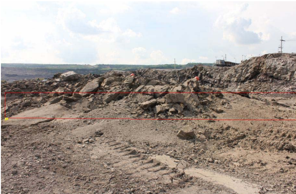
รูปที่ ผ6-15 ชุดการศึกษาที่ 15 รูปแบบของการศึกษาระเบิดเป็นแผง โดยมีการระเบิดหน้าเรียบ ล้วงหน้าและเทคนิคการระเบิดแบบเว้นช่องลม ระยะห่างระหว่างรูเจาะ 21.1 เท่าของขนาดรูเจาะ หรือ 3.8 เมตร ที่ขนาดหัวเจาะ 181 มิลลิเมตร ที่ความลึกรูเจาะ 15 เมตร Explosive Factor 0.35 \text{kg/m}^3
