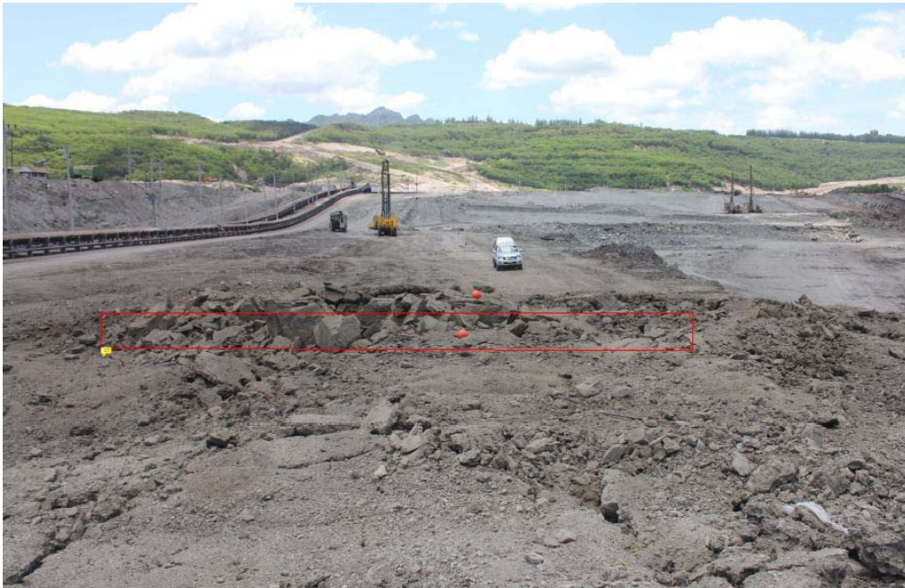
รูปที่ ผ6-7 ชุดการศึกษาที่ 2 รูปแบบของการศึกษาระเบิดเป็นแผง โดยมีการระเบิดหน้าเรียบล่วงหน้า โดยเทคนิคการระเบิดเว้นช่องลม ที่ขนาดหัวเจาะ 181 มิลลิเมตร ที่ความลึกเจาะ 10 เมตร ที่ Explosive Factor 0.28 kg/m 3
