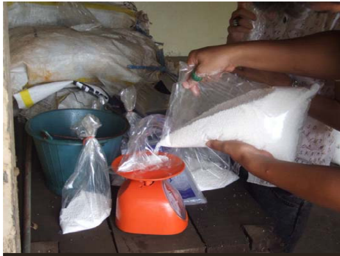
รูปที่ ๗1-10 Ammonium Nitrate (ANFO)
