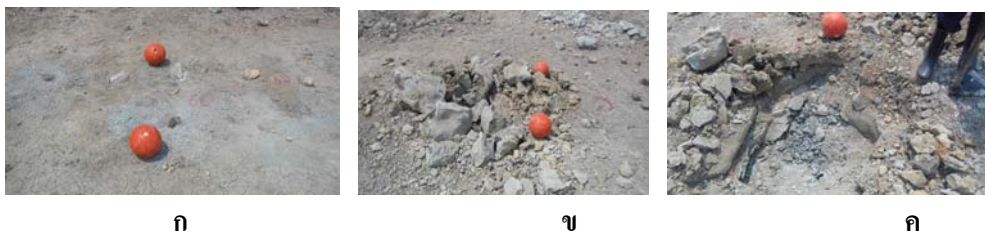
รูปที่ ๗4-3 ฟังและผลการระเบิดระยะระหว่างรูระเบิดถึงแนวรูว่าง 60 เซนติเมตร และระยะระหว่างรูว่าง 60 เซนติเมตร
