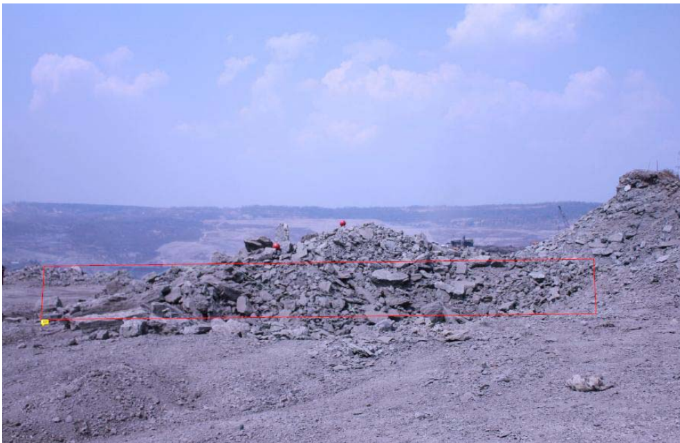
รูปที่ ผ6-2 ระเบิดเป็นแผง โดยใช้แนวรูวางเป็นหน้าอิสระ และมีการหน่วงเวลาที่ระเบิด 2 ช่วง
