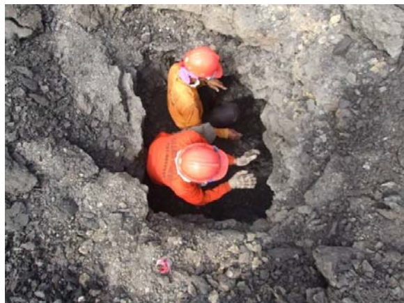
รูปที่ ๗4-11 ผลการระเบิดชุดการทดลองที่ใช้รูระเบิด 4 รู ระยะห่างของรูว่างและรูระเบิดทั้งหมด 40 cm
