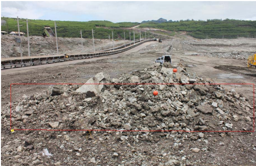
รูปที่ ผ6-10 ชุดการศึกษาที่ 5 รูปแบบของการศึกษาระเบิดเป็นแผง โดยมีการระเบิดหน้าเรียบ ล่องหน้า โดยเทคนิคการระเบิดเว้นช่องลมที่ขนาดหัวเจาะ 181 มิลลิเมตร 18.4เท่าของขนาดรูเจาะ หรือ 3.3 เมตร ที่ความลึกรูเจาะ 10 เมตร ค่า Explosive Factor 0.35 \text{ kg/m}^3
