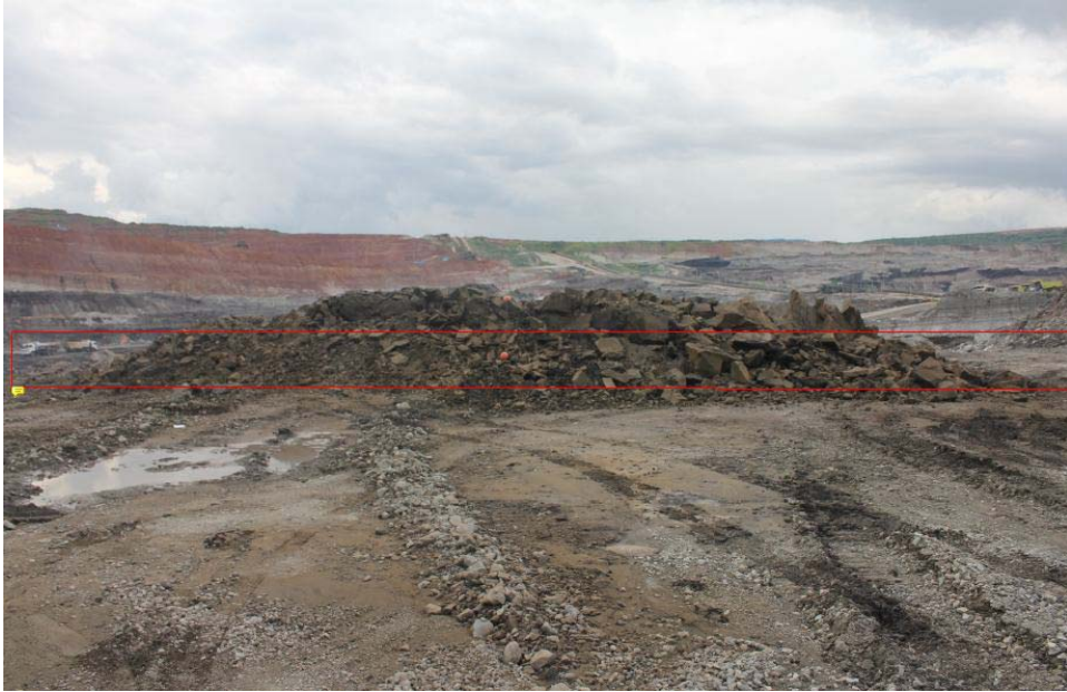
รูปที่ ผ6-14 ชุดการศึกษาที่ 14 รูปแบบของการศึกษาระเบิดเป็นแผง โดยมีการระเบิดหน้าเรียบ ล้วงหน้าและเทคนิคการระเบิดแบบเว้นช่องลม ระยะห่างระหว่างรูเจาะ 18.4 เท่าของขนาดรูเจาะ หรือ 3.3 เมตร ที่ขนาดหัวเจาะ 181 มิลลิเมตร ที่ความลึกรูเจาะ 15 เมตร Explosive Factor 0.35 \text{kg/m}^3
