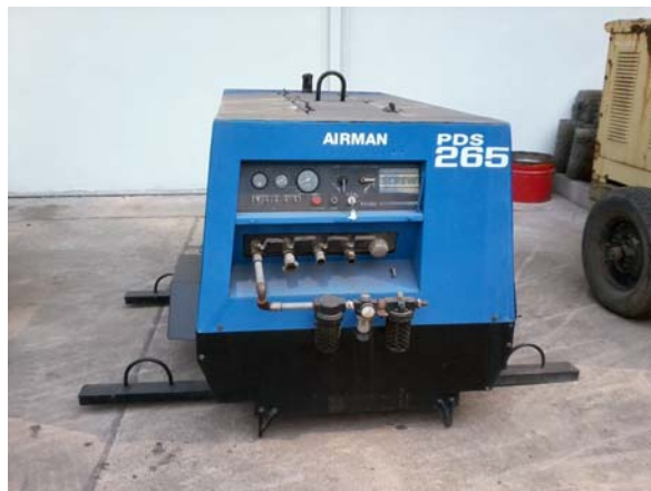
รูปที่ ผ1-2 เครื่องปั๊มลม (Air Compressor)
