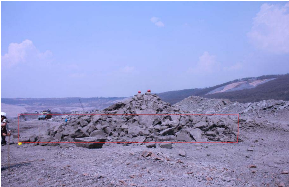
รูปที่ ๗6-3 ระเบิดเป็นแผง โดยใช้แนวรูวางเป็นแนวระเบิดหน้าเรียบลุ่มหน้า เพื่อทำหน้าที่เป็นหน้าอิสระ โดยใช้เทคนิค Decoupling และ การระเบิดเว้นช่องลม
