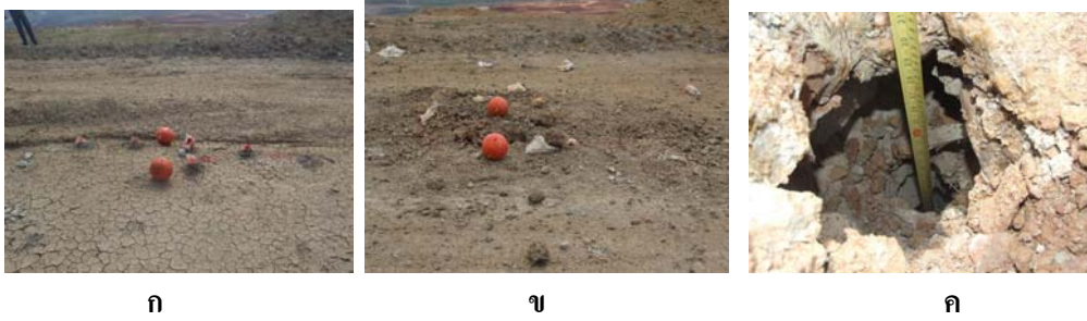
รูปที่ ๗4-9 ผังและผลการระเบิดที่ใช้รูระเบิด 2 รู ระยะระหว่างรูระเบิดถึงแนวรูว่าง 20 เซนติเมตร และระยะระหว่างรูว่าง 20 เซนติเมตร
