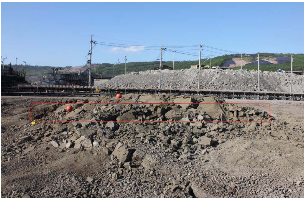
รูปที่ ผ6-8 ชุดการศึกษาที่ 3 รูปแบบของการศึกษาระเบิดเป็นแผง ที่ขนาดหัวเจาะ 181 มิลลิเมตร ความลึกเจาะ 10 เมตร โดยมีการระเบิดหน้าเรียบล่วงหน้า โดยเทคนิคการระเบิดเว้นช่องลมและไม่อุดปากเจาะ ค่า Explosive Factor 0.35 kg/m 3
