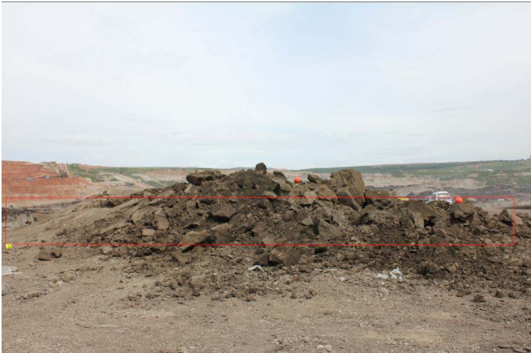
รูปที่ ผ6-9 ชุดการศึกษาที่ 4 รูปแบบของการศึกษาระเบิดเป็นแผง ที่ขนาดหัวเจาะ 181 มิลลิเมตร ความลึกรูเจาะ 10 เมตร โดยมีการระเบิดหน้าเรียบล่องหน้า โดยเทคนิคการระเบิดเว้นช่องลม ค่า Explosive Factor 0.12 \text{ kg/m}^3 โดยมีการบรรจุวัตถุระเบิดในรูเจาะทุกรูไม่มีการเว้นรูว่าง
