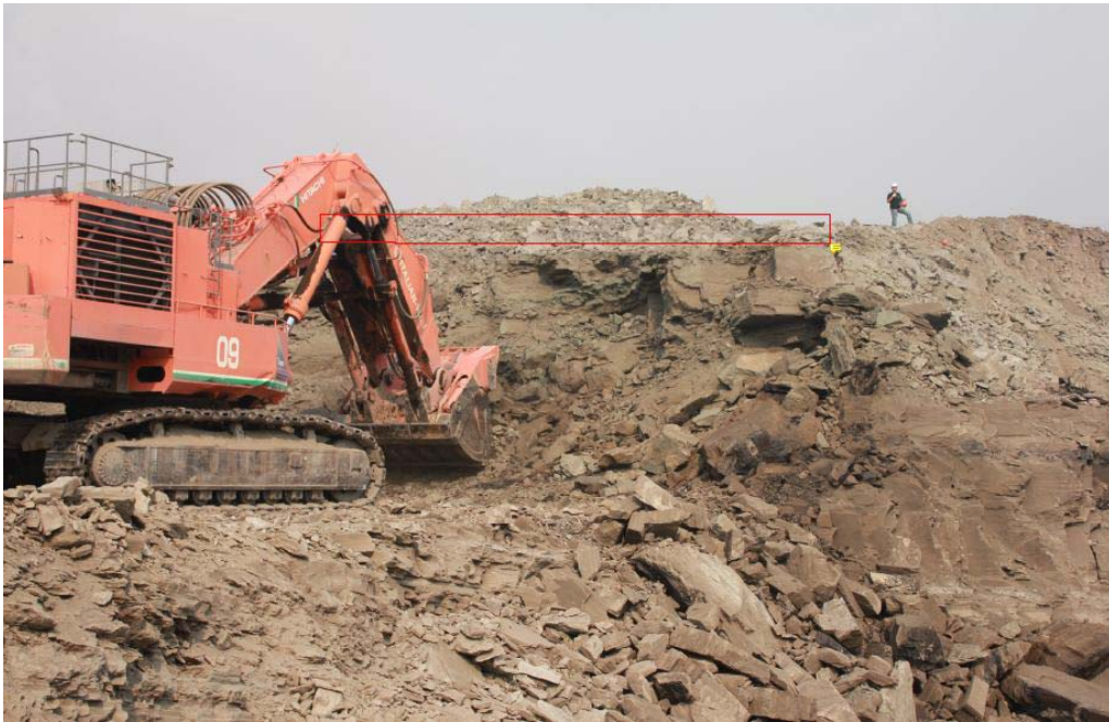
รูปที่ ๗6-5 ศึกษาซ้ำครั้งที่ 2 ระเบิดเป็นแผง โดยใช้แนวรูวางเป็นแนวระเบิดหน้าเรียบล่องหน้า เพื่อทำหน้าที่เป็นหน้าอิสระ โดยใช้เทคนิคDecoupling และการระเบิดเว้นช่องลม
