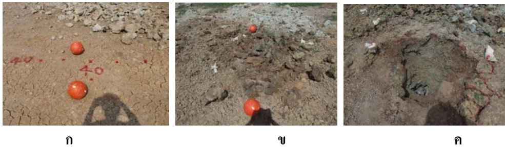
รูปที่ ๗4-2 ฟังและผลการระเบิดระยะระหว่างรูระเบิดถึงแนวรูว่าง 40 เซนติเมตร และระยะระหว่างรูว่าง 40 เซนติเมตร
