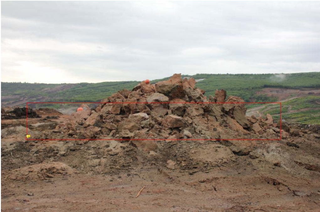
รูปที่ ผ6-16 ชุดการศึกษาที่ 16 รูปแบบของการศึกษาระเบิดเป็นแผง โดยมีการระเบิดหน้าเรียบ ล่วงหน้า ระยะห่างระหว่างรูเจาะ 18.4 เท่าของขนาดรูเจาะหรือ 3.3 เมตร ที่ขนาดหัวเจาะ 181 มิลลิเมตร ที่ความลึกรูเจาะ 30 เมตร ค่า Explosive Factor 0.38 kg/m 3
