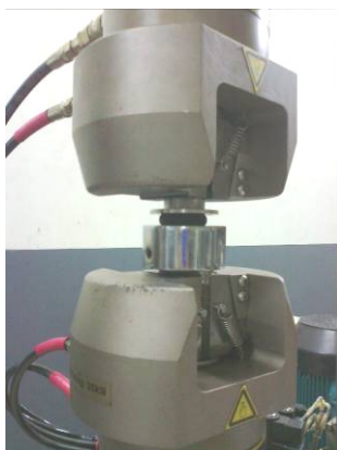
รูปที่ 3.26 ทดสอบการกดด้วยเครื่องทดสอบสมบัติวัสดุเอนกประสงค์
