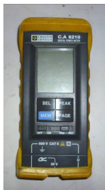
รูปที่ 3.1 เครื่องมือวัดกำลังไฟฟ้า
