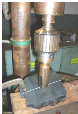
รูปที่ 3.23 การเจาะยางให้ได้ทรงกระบอก
