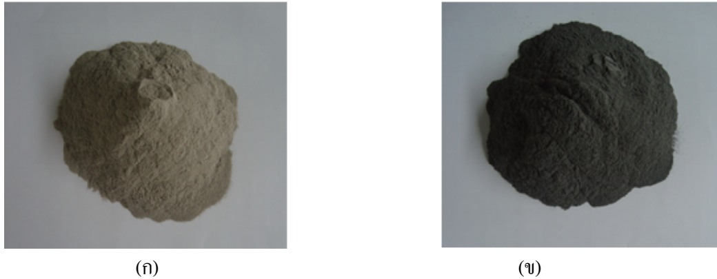
รูปที่ 3.2 (ก) ลักษณะขี้ปซัมเทียม (FGD) (ข) ลักษณะเถ้าไพล่าม่น้ำมัน (PPFA)
