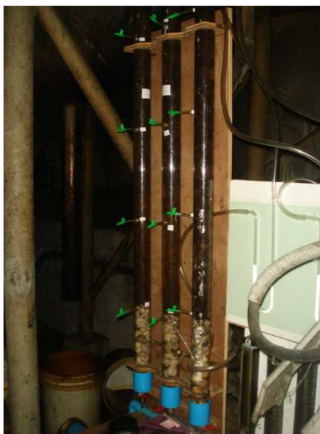
ภาพประกอบ 3-2 เครื่องกรองชีวภาพระดับห้องปฏิบัติการ ติดตั้งที่ บริษัท สยามอินโดรับเบอร์ จำกัด
