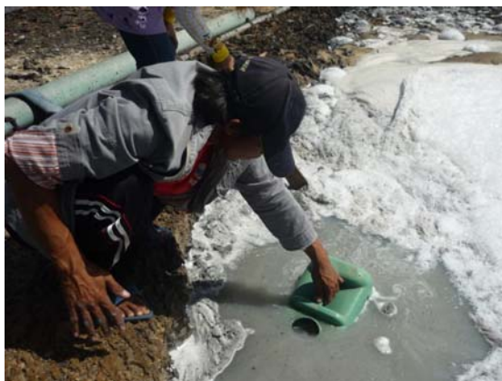
ภาพประกอบ 2-1 การเก็บตัวอย่างน้ำเสียแบบจ้วง (Grab Sampling) จากบริษัททดลองอุตสาหกรรมน้ำยางชั้น
