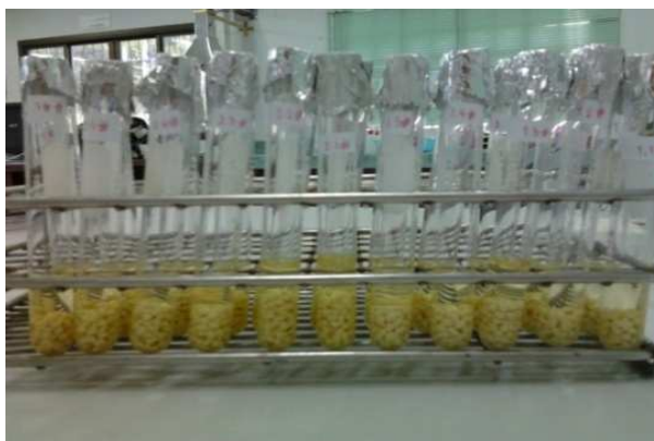
รูปที่ 3.2 การแช่เม็ดบีดในสารละลาย PBS เพื่อศึกษาการปลดปล่อยยาในช่วงเวลาต่าง ๆ กัน
