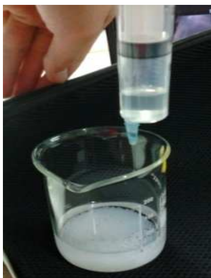
รูปที่ 3.1 การเตรียมเม็ดปิดไคโตซาน โดยวิธีการครอสลิงก์กับ TPP
