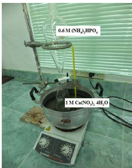
ภาพประกอบที่ 3.1 การทำปฏิกิริยาระหว่าง 1 \text{ M Ca(NO}_3)_2 \cdot 4\text{H}_2\text{O} และ 0.6 \text{ M (NH}_4)_2\text{HPO}_4
