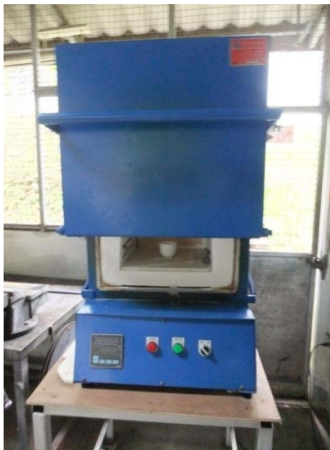
ภาพประกอบที่ 3.2 เตาเผาที่ใช้ในการเผาแคลไซต์ที่ 900°C
