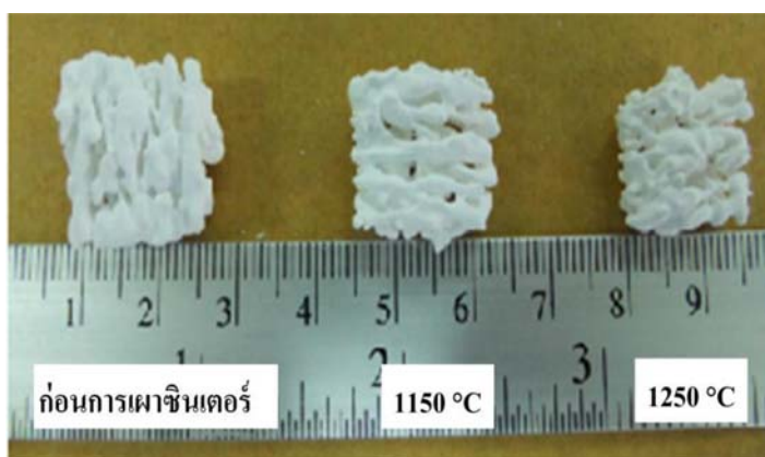
ภาพประกอบที่ 3.6 โครงเลี้ยงเซลล์ที่ผ่านการขึ้นรูปด้วยวิธีจุ่มเคลือบ ก่อนและหลังการเผาซินเตอร์ที่อุณหภูมิ 1150^\circ\text{C} และ 1250^\circ\text{C}
