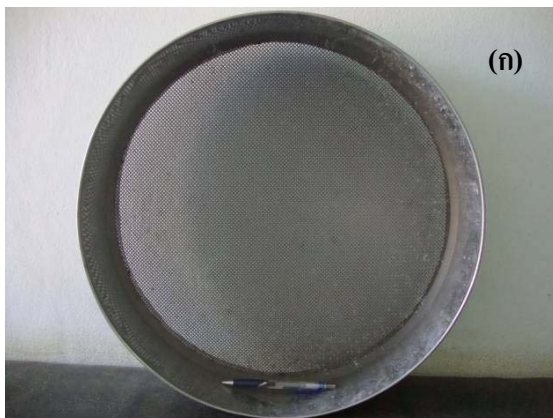
รูปที่ 2.5 (ก) ตะแกรงมาตรฐาน และ (ข) เครื่องแบ่งตัวอย่าง Jones's Riffle
