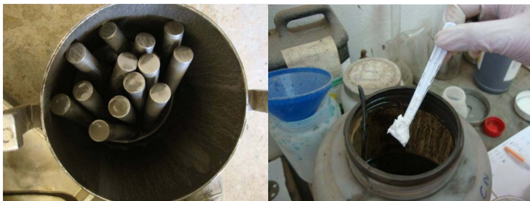
รูปที่ 2.7 บดละเอียดด้วย Rod Mill และ วัดค่า DO และปรับค่า pH โดยการเติมปูนขาว
