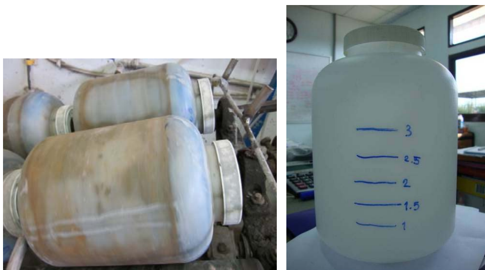
รูปที่ 2.2 ขวดพลาสติก ใช้เป็นหม้อหมุนละลายแร่
