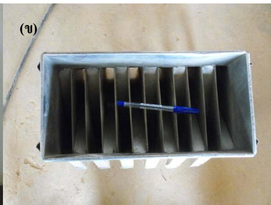
รูปที่ 2.5 (ก) ตะแกรงมาตรฐาน และ (ข) เครื่องแบ่งตัวอย่าง Jones's Riffle
