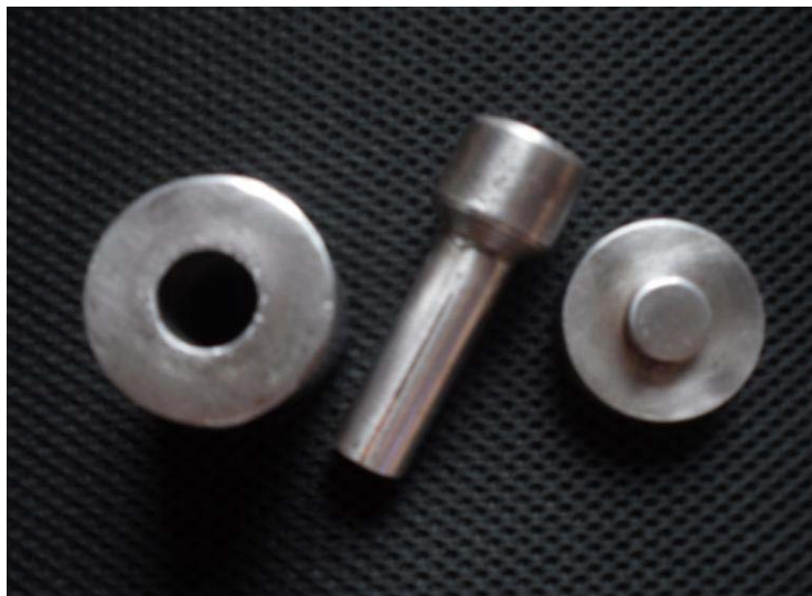
ภาพประกอบที่ 2.2 แม่พิมพ์เหล็กที่ใช้เตรียม โครงเลี้ยงเซลล์ที่มีขนาดเส้นผ่าศูนย์กลาง 1 เซนติเมตร และอัดด้วยเครื่อง ไฮดรอลิก
