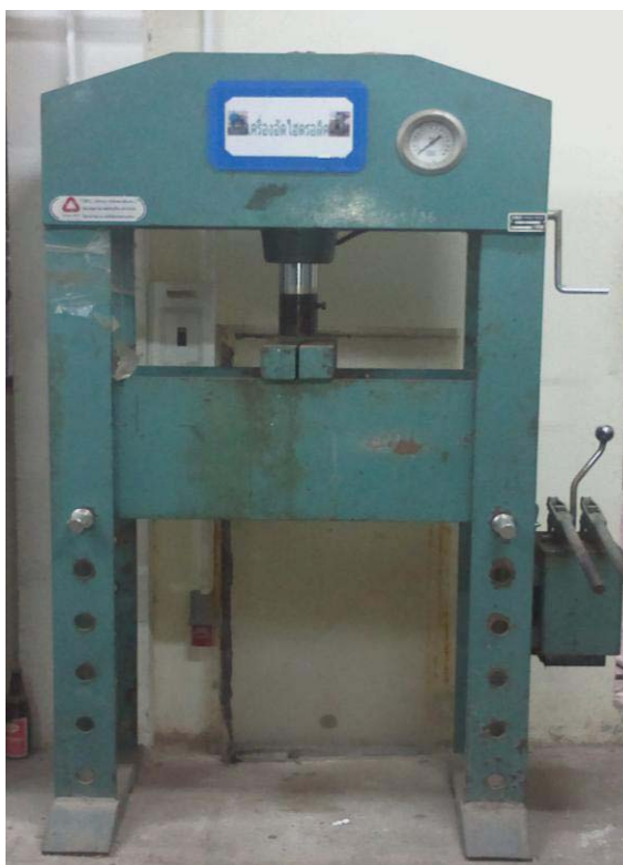
ภาพประกอบที่ 2.3 เครื่องอัด ไฮดรอลิกสำหรับใช้ขึ้นรูป โครงเลี้ยงเซลล์
