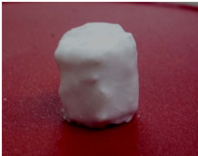
รูปที่ 3.5 โครงเลี้ยงเซลล์หลังการเคลือบด้วยสารเคลือบพอลิเมอร์
