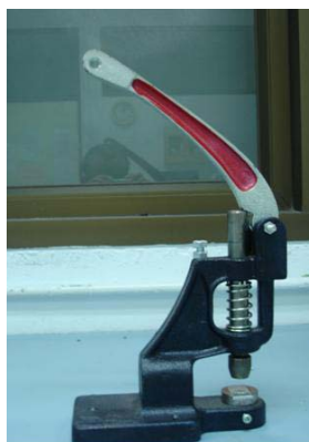
ภาพประกอบที่ ก-1 เครื่องตัดแผ่นยางตัวอย่าง
