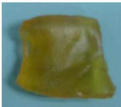
ภาพประกอบที่ ก-9 ยางเครพขาวที่ตัดให้มีน้ำหนัก 12.5 กรัม
