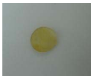
ภาพประกอบที่ ก-2 แผ่นยางตัวอย่างที่ผ่านการตัดด้วยเครื่องตัดตัวอย่าง
