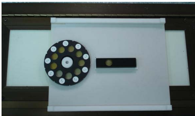
ภาพประกอบที่ ก-6 แสดงการวางแม่สีและที่ใส่ตัวอย่างบนเครื่อง Lovibond
