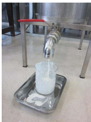
ภาพประกอบที่ 3-11 แสดงการเปิดวาล์วถ่ายน้ำยางใส่ถาดเพื่อจับตัวเป็นแผ่น
