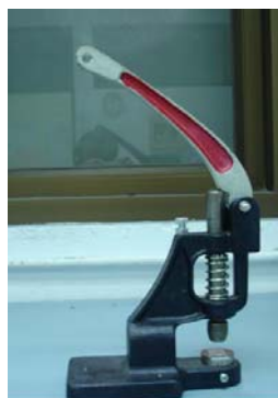
ภาพประกอบที่ 3-7 แสดงเครื่องตัดยางตัวอย่าง
