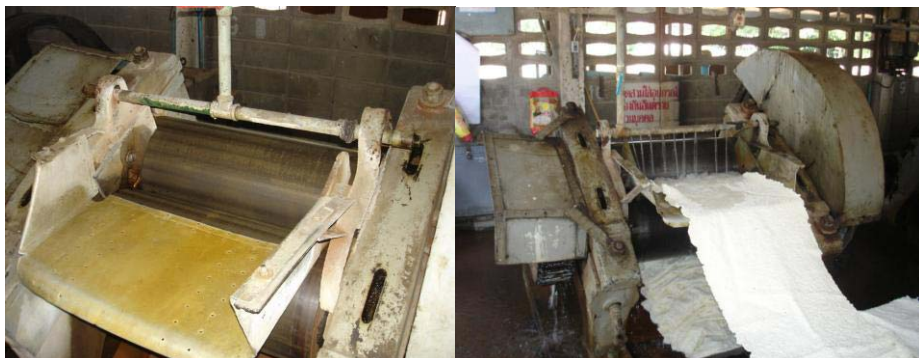
ภาพประกอบที่ 2-5 แสดงจักรรีดยางขนาดอุตสาหกรรม ที่มา : องค์การสวนยาง กระทรวงเกษตรและสหกรณ์
