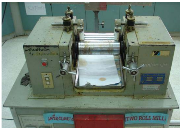
ภาพประกอบที่ ก-8 เครื่องบดผสมยางสองลูกกลิ้ง
