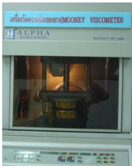
ภาพประกอบที่ ก-19 การทำงานของเครื่อง Mooney Viscometer MV2000
