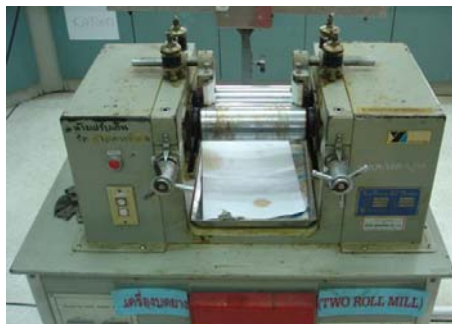
ภาพประกอบที่ 3-8 แสดงเครื่องบดผสมยางสองลูกกลิ้ง
