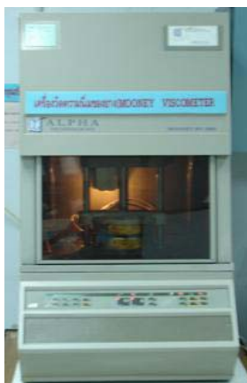
ภาพประกอบที่ 3-5 แสดงเครื่องวัดความหนืดมูนี (Mooney Viscometer,MV2000)
