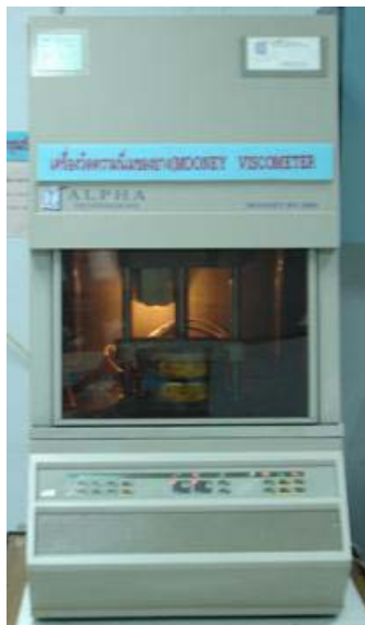
ภาพประกอบที่ ก-13 เครื่องวัดความหนืด (Mooney Viscometer,MV2000)
