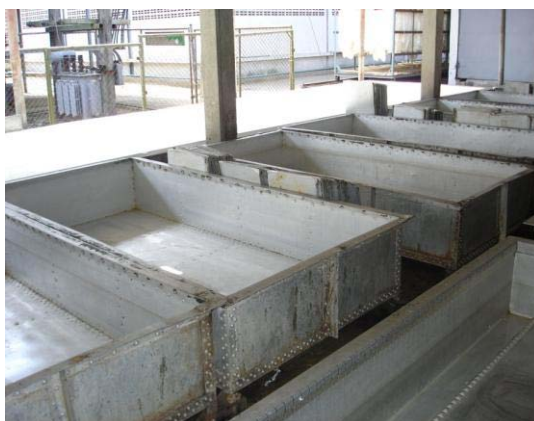
ภาพประกอบที่ 2-4 แสดงตะกุงน้ำยาง ที่มา : องค์การสวนยาง กระทรวงเกษตรและสหกรณ์
