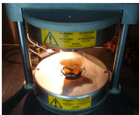
ภาพประกอบที่ ก-18 การใส่แผ่นยางเครพขาวตัวอย่างใน Platens
