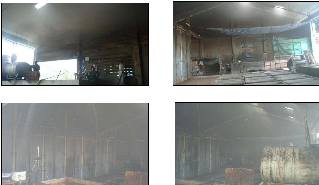
ภาพที่ 3-6 ลักษณะการกระจายของควันภายในโรงงานรมควันยางแผ่น สกย.จังหวัดสงขลา
