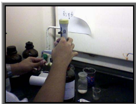
ภาพที่ ง-3 นำ coconut shell charcoal ในขวด Vial เติม CS_2 1 ml ปิดฝา
