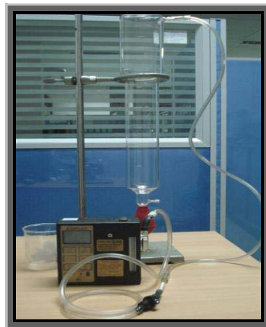
ภาพที่ ค-2 อุปกรณ์ปรับเทียบมาตรฐานความถูกต้องของอัตราการไหลอากาศ (calibration)
