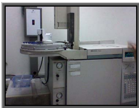
ภาพที่ ง-5 นำไปวิเคราะห์ด้วยเครื่อง GC/FID ที่สภาวะเหมาะสมตัวอย่างละ 13 นาที
