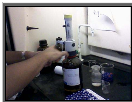
ภาพที่ ง-3 นำ coconut shell charcoal ในขวด Vial เติม CS_2 1 ml ปิดฝา
