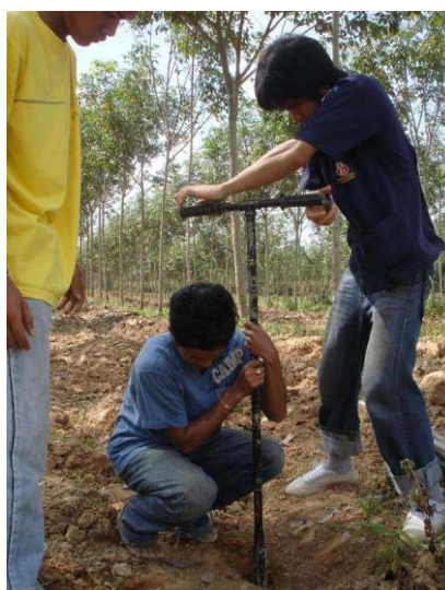
รูปที่ 3.4 การเก็บตัวอย่างดินโดยใช้ Hand auger
