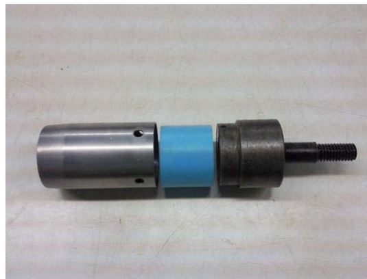
รูปที่ 3.7 ชุดเก็บตัวอย่างดินที่ดัดแปลงมาใช้ในการเก็บตัวอย่างดินบริเวณคลังคลองอุตะเถา
