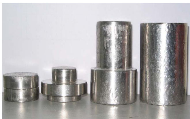
ภาพประกอบที่ 3 [3] แสดงเบ้าอัดตัวเร่งปฏิกิริยา
