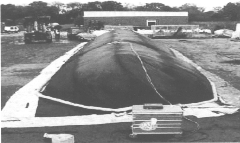
รูปที่ 2.9 กองหมักแบบใช้เครื่องเติมอากาศ (Aerated Static Pile)
