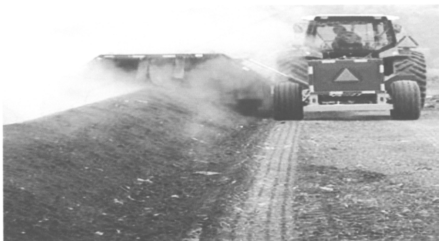
รูปที่ 2.6 การพลิกกลับกองปุ๋ยหมักแบบ Windrow โดยใช้เครื่องจักรกล (ที่มา : http://pubs.ext.vt.edu/452/452-230/L_IMG_Tractor.jpg )
