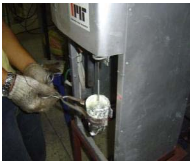
รูปที่ 3.4 แสดงการปล่อยฟองแก๊สในน้ำโลหะกึ่งของแข็งผ่านแท่งกราไฟท์พอร์น
