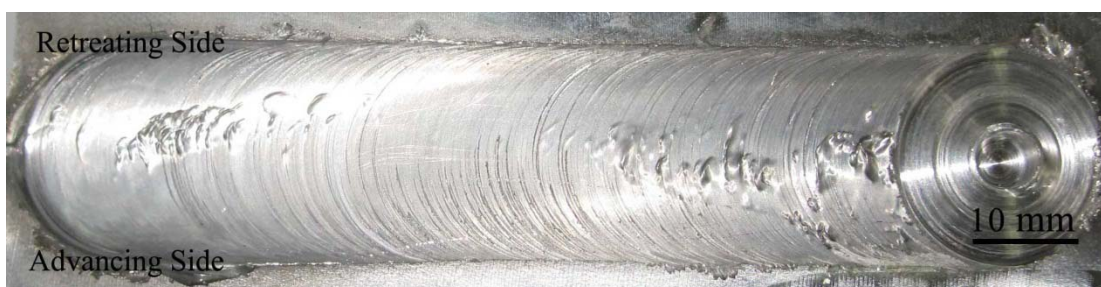
(ค) แนวเชื่อมที่ความเร็วรอบ 1110 rpm ความเร็วเชื่อม 120 mm/min
