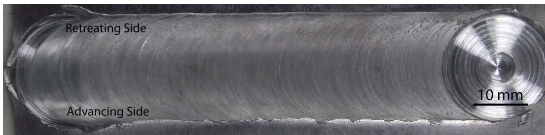
(ก) แนวเชื่อมที่ความเร็วรอบ 1320 rpm ความเร็วเชื่อม 70 mm/min
