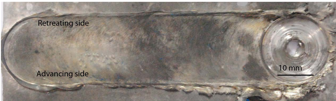
(ค) แนวเชื่อมที่ความเร็วรอบ 1110 rpm ความเร็วเชื่อม 110 mm/min หลังจากอบละลาย
