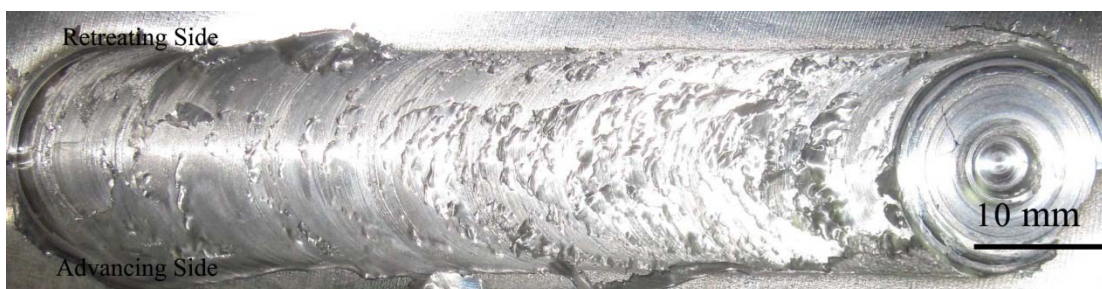
(ง) แนวเชื่อมที่ความเร็วรอบ 1110 rpm ความเร็วเชื่อม 160 mm/min
