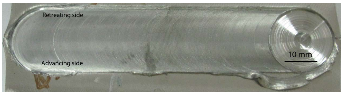
(จ) แนวเชื่อมที่ความเร็วรอบ 1110 rpm ความเร็วเชื่อม 90 mm/min
