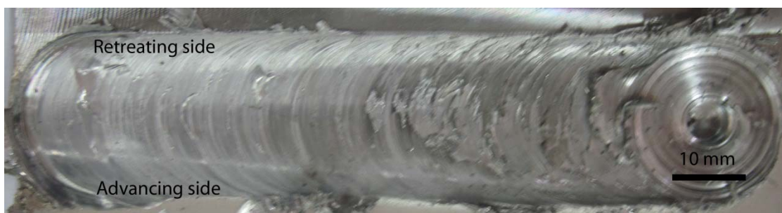
รูปที่ 3.17 รอยเชื่อมจากการเชื่อมเสียดทานแบบกวนที่ไม่สมบูรณ์
