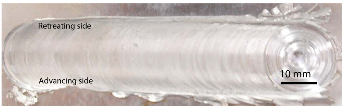
(ก) ความเร็วรอบ 1110 rpm ความเร็วเชื่อม 70 mm/min หลังจากบ่มที่อุณหภูมิ 120 °C เป็นเวลา 36 ชั่วโมง
