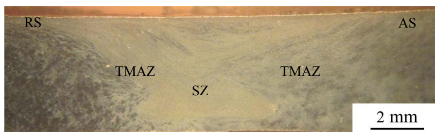
(ข) โครงสร้างมหภาคที่ความเร็วรอบ 1110 rpm ความเร็วเชื่อม 90 mm/min
