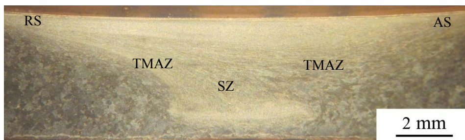
รูปที่ 4.14 โครงสร้างมหภาคที่ความเร็วรอบ 1110 rpm หลังจากบ่มที่ 24 ชั่วโมง
