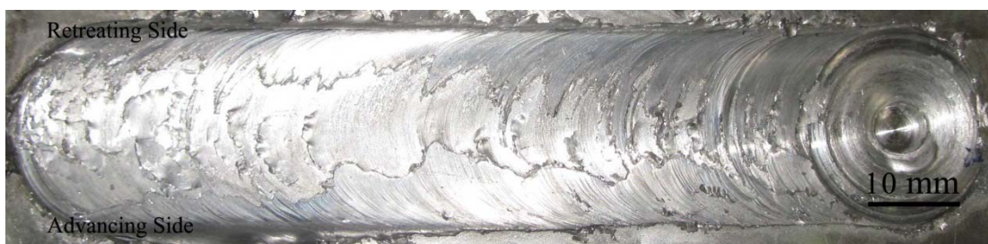
(ก) แนวเชื่อมที่ความเร็วรอบ 1110 rpm ความเร็วเชื่อม 40 mm/min
