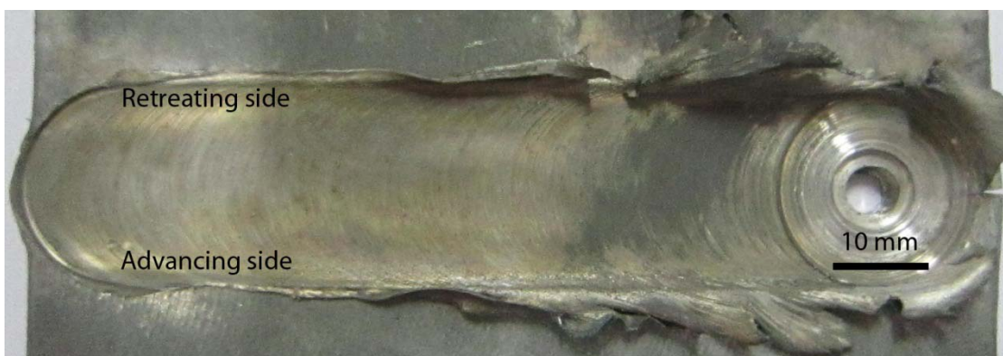
(ก) แนวเชื่อมที่ความเร็วรอบ 1110 rpm ความเร็วเชื่อม 70 mm/min หลังจาก T6
