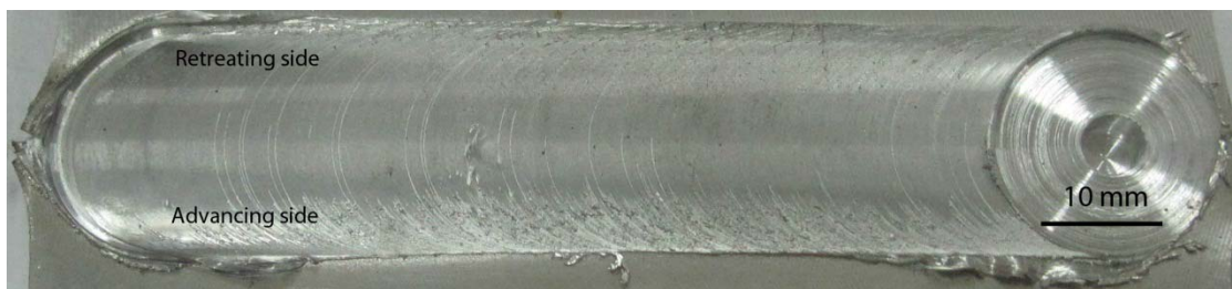
(ฉ) แนวเชื่อมที่ความเร็วรอบ 1110 rpm ความเร็วเชื่อม 110 mm/min
