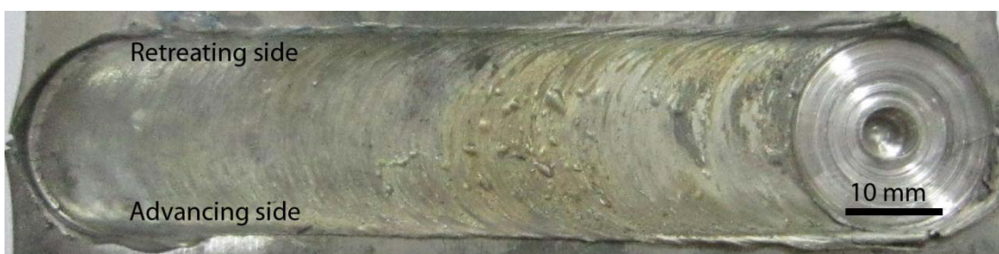
(ข) แนวเชื่อมที่ความเร็วรอบ 1110 rpm ความเร็วเชื่อม 90 mm/min หลังจาก T6
