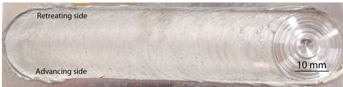
(ข) ความเร็วรอบ 1110 rpm ความเร็วเชื่อม 90 mm/min หลังจากบ่มเทียม 36 ชั่วโมง
