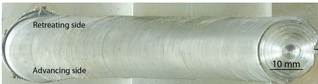
(ค) แนวเชื่อมที่ความเร็วรอบ 1320 rpm ความเร็วเชื่อม 110 mm/min
