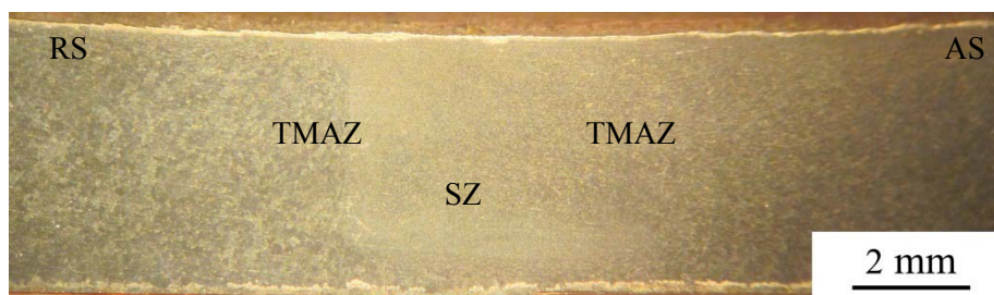
(ก) โครงสร้างมหภาคที่ 1110 rpm ความเร็วเชื่อม 70 mm/min หลังจาก T6
