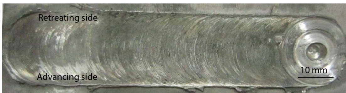
(ค) แนวเชื่อมที่ความเร็วรอบ 1110 rpm ความเร็วเชื่อม 110 mm/min หลังจาก T6
