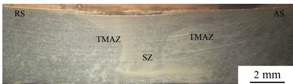
(ข) โครงสร้างมหภาคที่ 1110 rpm ความเร็วเชื่อม 90 mm/min หลังจากบ่มเทียม 36 ชั่วโมง
