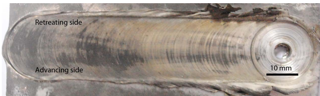
(ก) แนวเชื่อมที่ความเร็วรอบ 1110 rpm ความเร็วเชื่อม 70 mm/min หลังจากอบละลาย
