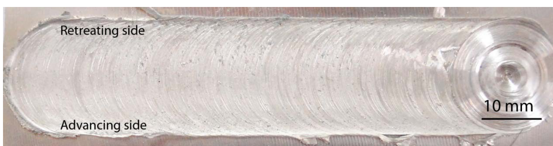
(ค) ความเร็วรอบ 1110 rpm ความเร็วเชื่อม 110 mm/min หลังจากบ่มเทียม 36 ชั่วโมง
