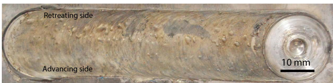
(ข) แนวเชื่อมที่ความเร็วรอบ 1110 rpm ความเร็วเชื่อม 90 mm/min หลังจากอบละลาย
