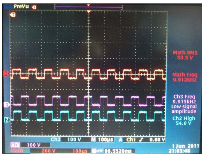
ภาพประกอบที่ 12 แรงดันไฟฟ้าขาออกของวงจรมอเตอร์เมื่อต่อโหลด 50 โอห์ม
