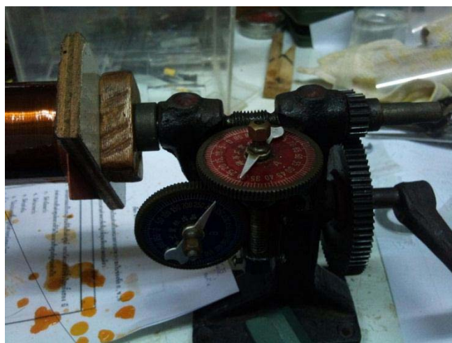
ภาพประกอบที่ 10 มาตรวัดจำนวนรอบขดลวดของหม้อแปลงไฟฟ้า
