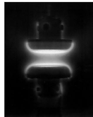
ภาพประกอบที่ 1.26 พลาสมาของอาร์กอนเมื่อจ่ายแรงดันไฟฟ้าเป็นสัญญาณพัลส์สองทิศทางที่มีความถี่ 5 กิโลเฮิร์ตซ์[5]
