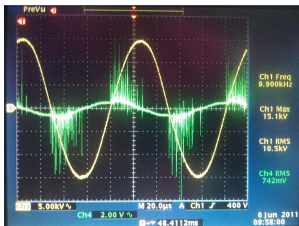
ภาพประกอบที่ 17 กระแสดีสชาร์จ (CH4) เทียบกับแรงดันไฟฟ้า (CH1) ที่จ่ายแต่ห้องพลาสมา
