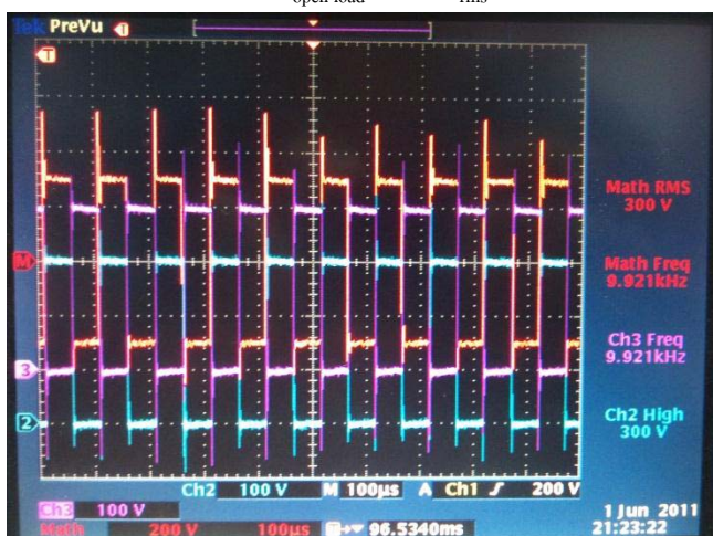
ภาพประกอบที่ 13 แรงดันไฟฟ้าขาออกของวงจรมอเตอร์เมื่อไม่ต่อโหลด ( V=300\text{ V}_{\text{rms}} )
