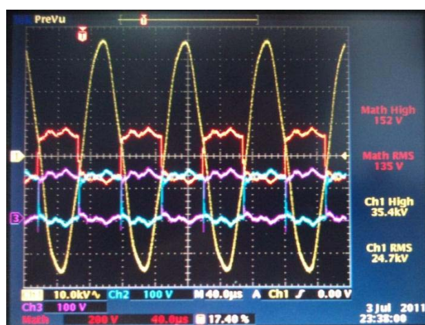
ภาพประกอบที่ 16 แรงดันไฟฟ้าขาออกของหม้อแปลงชั้นบันได(CH1) และแรงดันไฟฟ้าขาเข้า (Math) ที่แอมพลิจูดของแรงดันไฟฟ้าสูงสุดคือ 35 กิโลโวลต์
