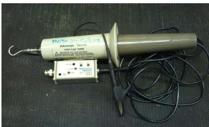
ภาพประกอบที่ 3.23 โพรบวัดแรงดันสูงรุ่น Tektronix P6015A
