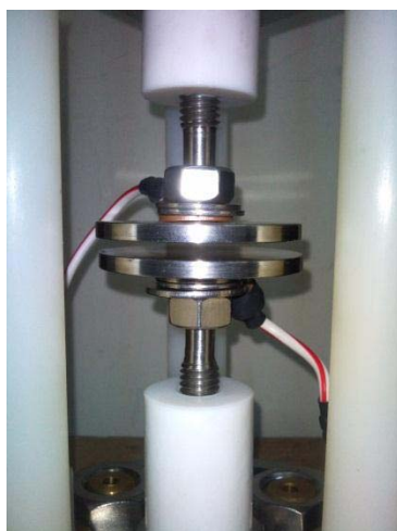
ภาพประกอบที่ 7 ขั้วไฟฟ้าสำหรับสร้างพลาสมาซึ่งสามารถปรับช่องว่างของอากาศได้
