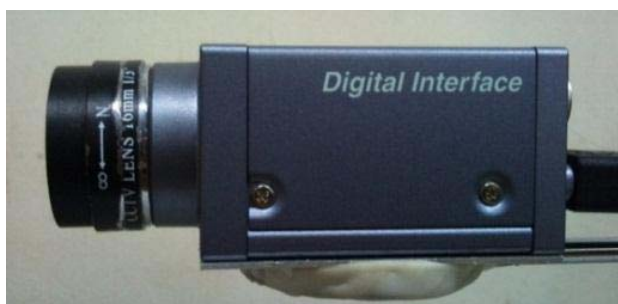
ภาพประกอบที่ 3.21 กล้องซีซีดี สำหรับจับภาพพลาสมา
