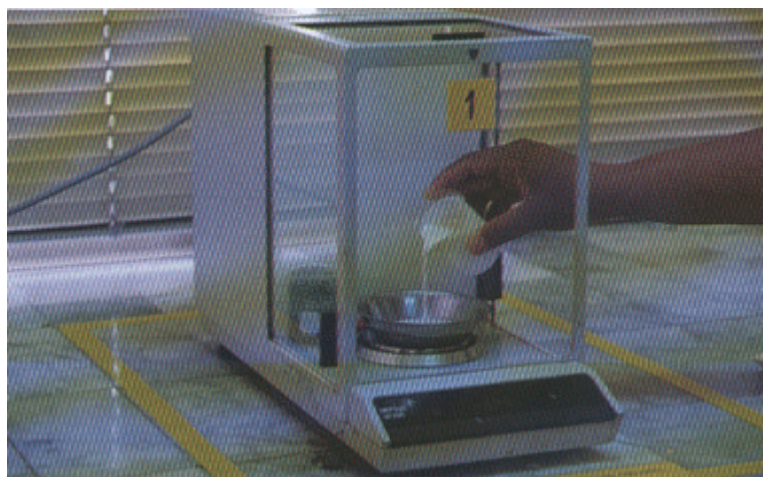
ภาพที่ 2.5 ชั่งน้ำยาง 50 กรัม โดยเครื่องชั่งชนิดละเอียด
