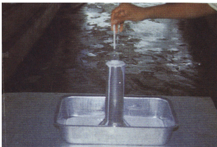
ภาพที่ 2.3 การหาปริมาณเนื้อยางแห้งโดยการวัดจากเมโทรแลค
