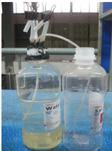
ภาพประกอบที่ 3-14 ชุดกักเก็บก๊าซชีวภาพแบบหมักร่วม ขนาดห้องปฏิบัติการระบบแบบกึ่งต่อเนื่อง
