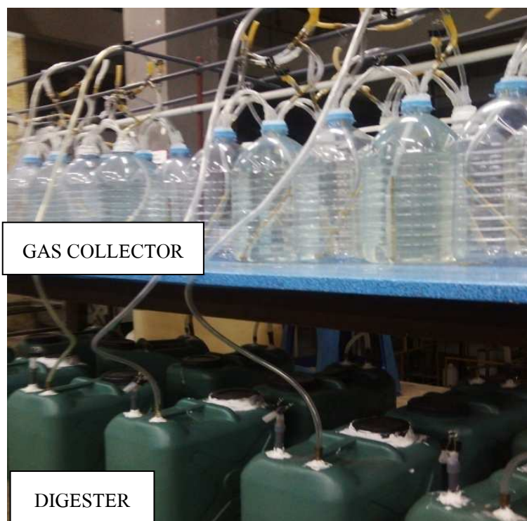
ภาพประกอบที่ 3-4 ชุดทดลองการหมักก๊าซชีวภาพแบบหมักกร่วม ระดับห้องปฏิบัติการระบบแบทช์
