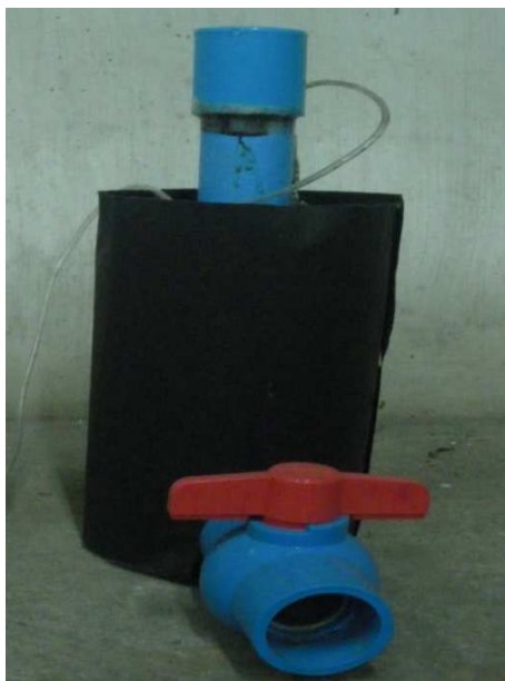
ภาพประกอบที่ 3-12 ถังหมักก๊าซชีวภาพแบบหมักรวม ขนาดห้องปฏิบัติการระบบแบบกึ่งต่อเนื่อง
