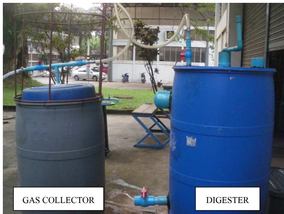
ภาพประกอบที่ 3-16 ชุดการทดลองผลิตก๊าซชีวภาพแบบหมักร่วม ขนาดต้นแบบระบบแบบกึ่งต่อเนื่อง
