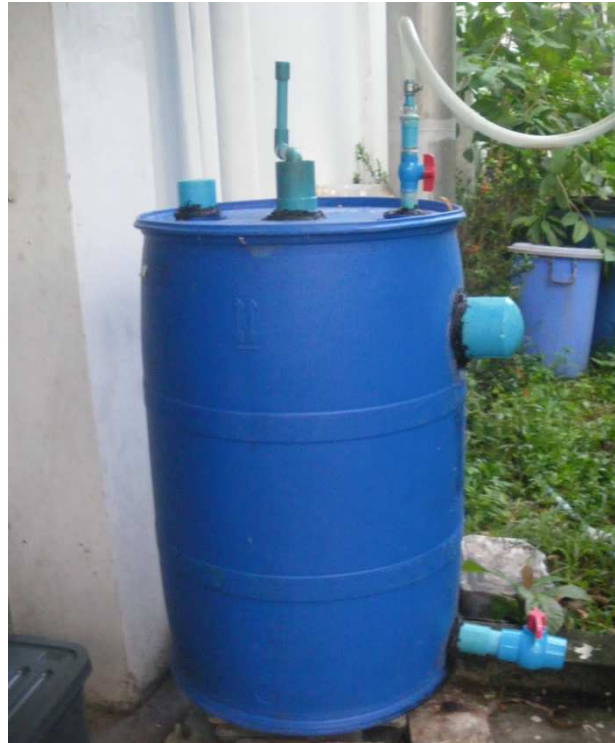
ภาพประกอบที่ 3-18 ถังหมักก๊าซชีวภาพแบบหมักร่วม ขนาดต้นแบบระบบแบบกึ่งต่อเนื่อง
