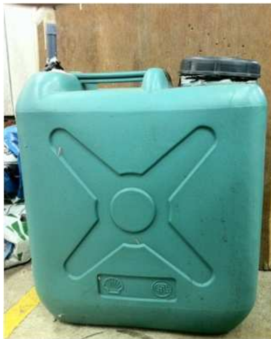
ภาพประกอบที่ 3-6 ถังหมักก๊าซชีวภาพแบบหมักร่วม ระดับห้องปฏิบัติการระบบแบทช์
