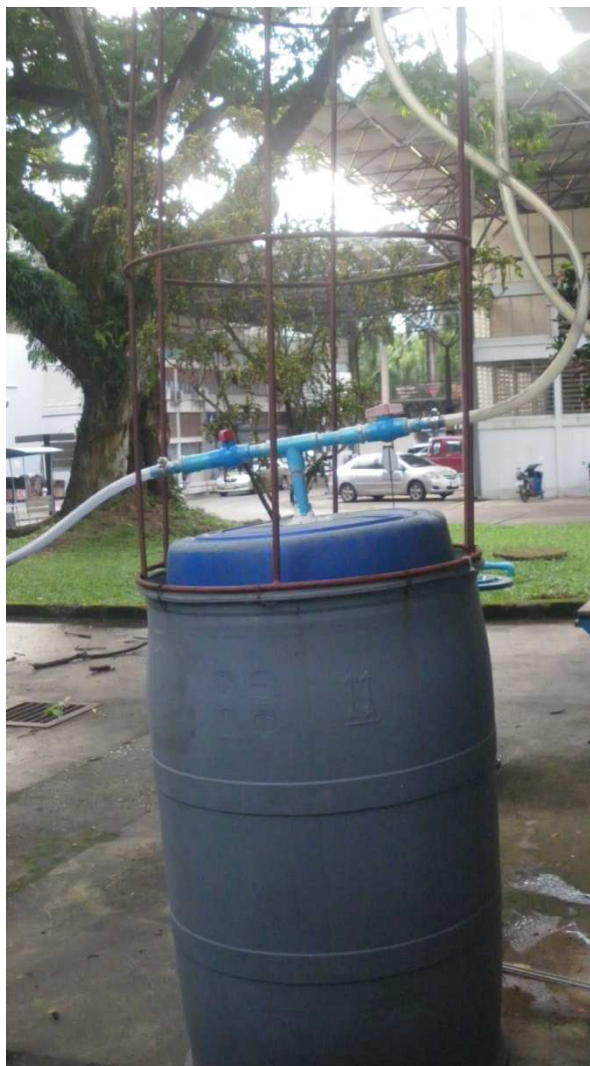
ภาพประกอบที่ 3-20 ชุดกักเก็บก๊าซชีวภาพแบบหมักร่วม ขนาดต้นแบบระบบแบบกึ่งต่อเนื่อง
