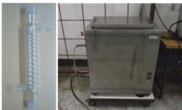
ภาพประกอบที่ 49 ชุดควบแน่นของเครื่องกลั่นเอทานอล
