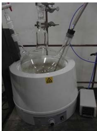
ภาพประกอบที่ 50 หม้อต้ม และชุดควบคุมอุณหภูมิของเครื่องกลั่นเอทานอล
