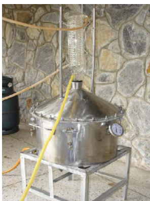
ภาพประกอบที่ 3 เครื่องกลั่นสุราแบบหม้อต้ม (สมบัติ, 2548)
