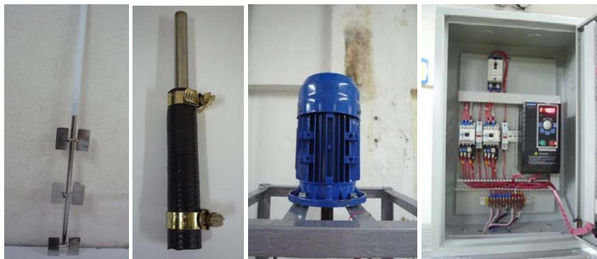
ภาพประกอบที่ 45 ชุดควานของถังปฏิกรณ์ชีวภาพ
