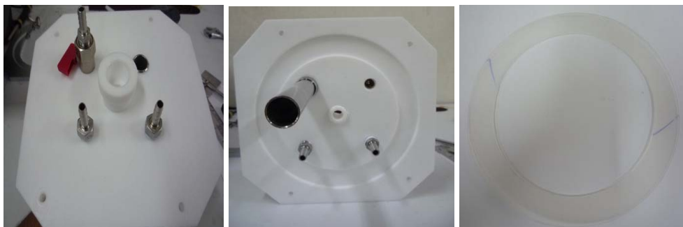
ภาพประกอบที่ 44 ชุดฝาถังของถังปฏิกรณ์ชีวภาพ
