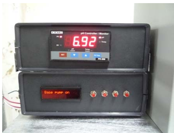
ภาพประกอบที่ 41 ชุดควบคุมพีเอชของถึงปฏิบัติการชีวภาพ
