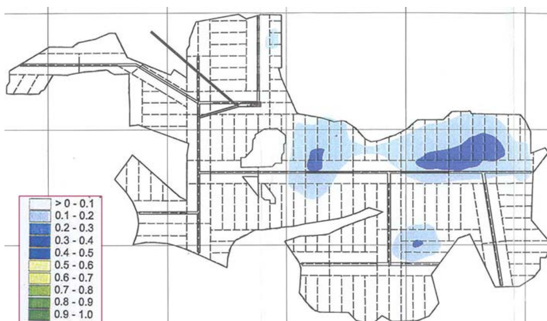
รูปที่ 3.33 ผลการทำนายการทรุดตัวของอุโมงค์เหมืองใต้ดิน โครงการเหมืองแร่โปแตชแหล่งอุดรใต้ปีที่ 5 (โครงการเหมืองแร่โปแตช บริษัท เอเซียแปซิฟิคโปแตชคอร์ปอเรชั่น จำกัด)
