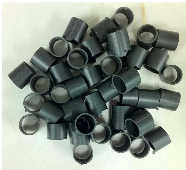
ภาพประกอบที่ 2.4 วัสดุที่ใช้เป็นตัวกลางกรอง (PVC raschig rings)
