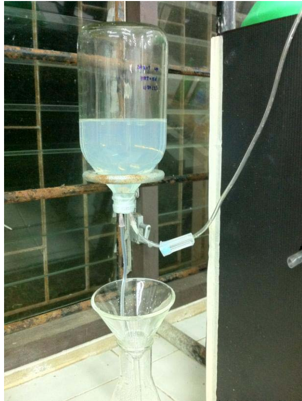
ภาพประกอบที่ 2.9 ชุดอุปกรณ์การวัดปริมาณแก๊สที่เกิดขึ้นด้วยวิธีการแทนที่น้ำ
