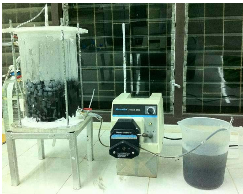
ภาพประกอบที่ 2.5 ลักษณะการทำงานของระบบบำบัดไม่ใช้ออกซิเจนแบบตรึงฟิล์ม (AFFR)
