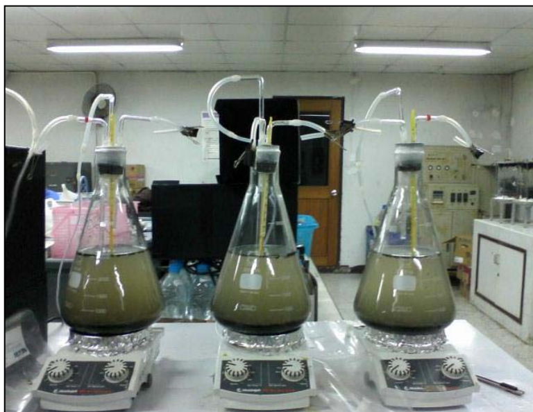
ภาพประกอบที่ 3.7 ลักษณะชุดอุปกรณ์ประกอบระบบ Semi- CSTR ที่ใช้ใน ห้องปฏิบัติการ
