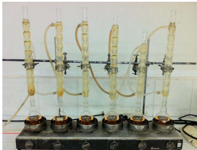
ภาพประกอบที่ ข-3 การประกอบชุดกลั่น COD แบบ Open Reflux
