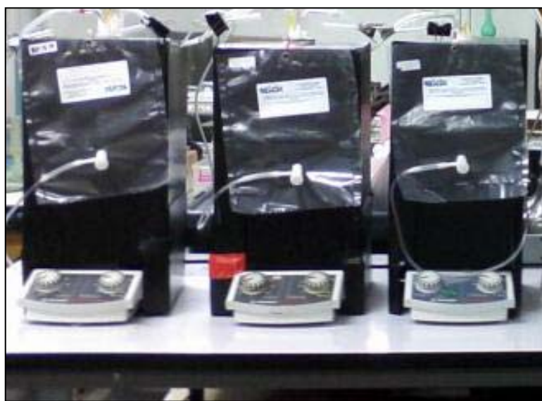
ภาพประกอบที่ 3.8 ลักษณะชุดอุปกรณ์ประกอบระบบ Semi-CSTR ในระหว่างการทดลอง ในห้องปฏิบัติการ
