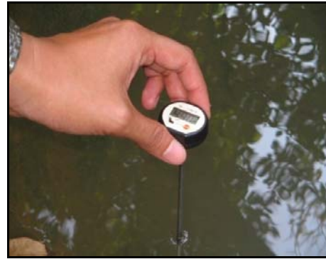
ภาพประกอบ 3.5 ข. วัดอุณหภูมิตัวอย่างน้ำพุร้อน
