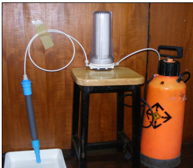
ภาพประกอบ 3.1 ชุดอุปกรณ์ที่ใช้จับเรเดียมน้ำ
