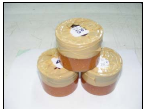
ภาพประกอบ 3.5 ฉ. นำสารจับเรเดียมน้ำบรรจุลงกระปุกและปิดผนึกตัวอย่าง
