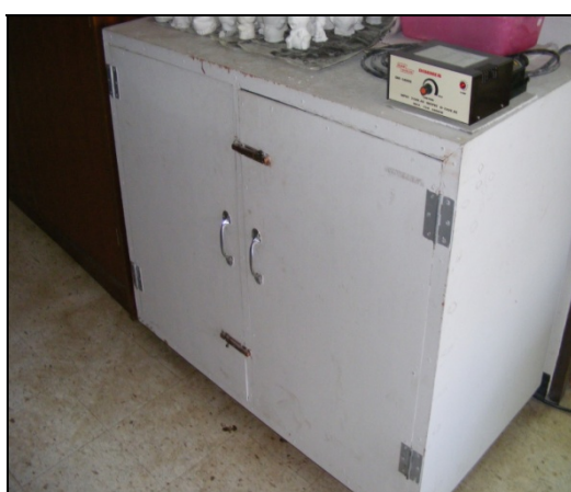
ภาพประกอบ 3.2 ก. เตาอบไฟฟ้าช่วง อุณหภูมิ 25-150°C
