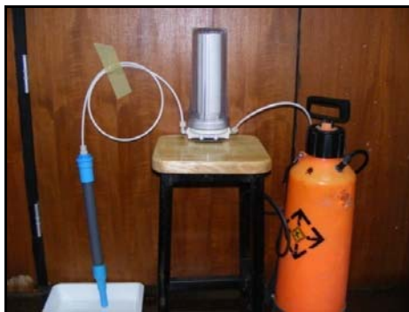
ภาพประกอบ 3.5 จ. นำตัวอย่างน้ำผ่านอุปกรณ์จับเรเดียมน้ำ ซึ่งภายในจะบรรจุสารดูดจับเรเดียมน้ำ (absorbant)
