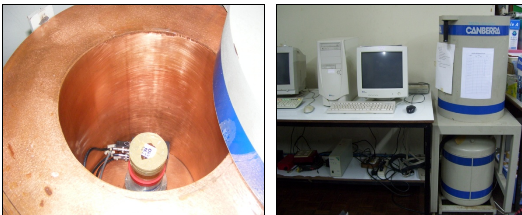
ภาพประกอบ 3.3 เครื่องสเปกโตรมิเตอร์รังสีแกมมา ชนิดหัววัดแบบ HPGe
